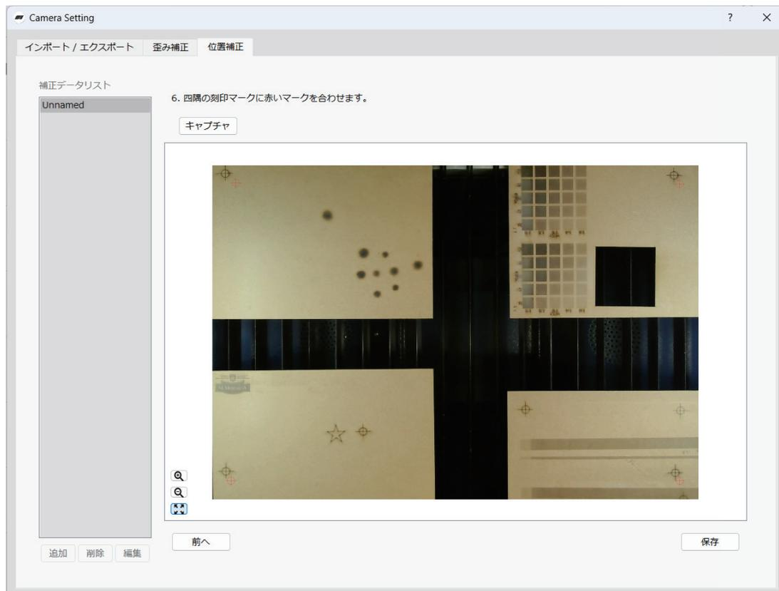
画面左下のズームツールや、キーボードのスペースを押しながらドラッグするパンツールを使用して、位置補正用マークを拡大します。
