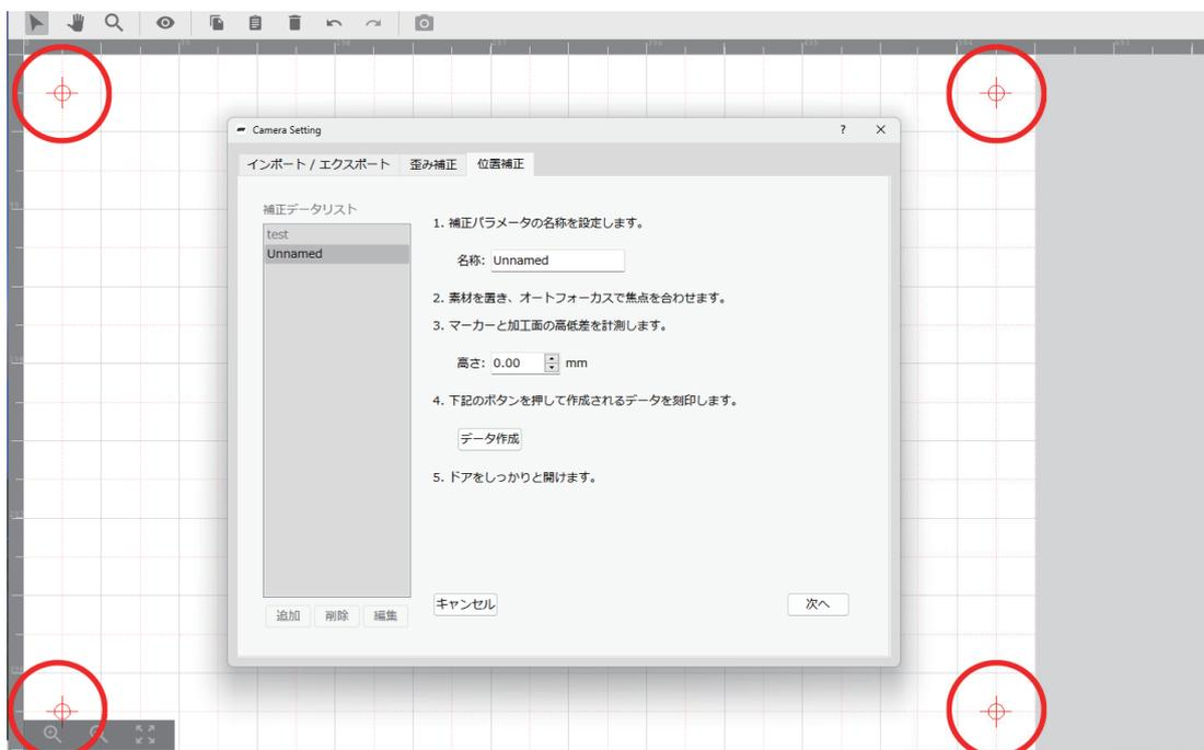
Camera Setting ウィンドウを開いたまま範囲確認をクリックします。するとレーザーヘッドが4つの位置補正用マークの外周を移動するため、この範囲の四隅にくるように素材の位置を調整してください。その後、ドアを閉め、START をクリックすると加工を開始します。
