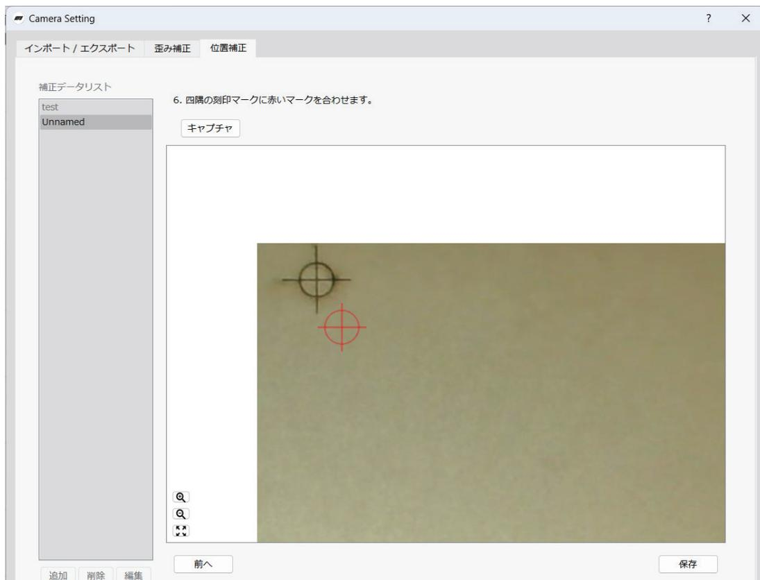
位置補正用マークをドラッグし、実際の加工位置に重なるように調整します。これを4箇所行ってください。
