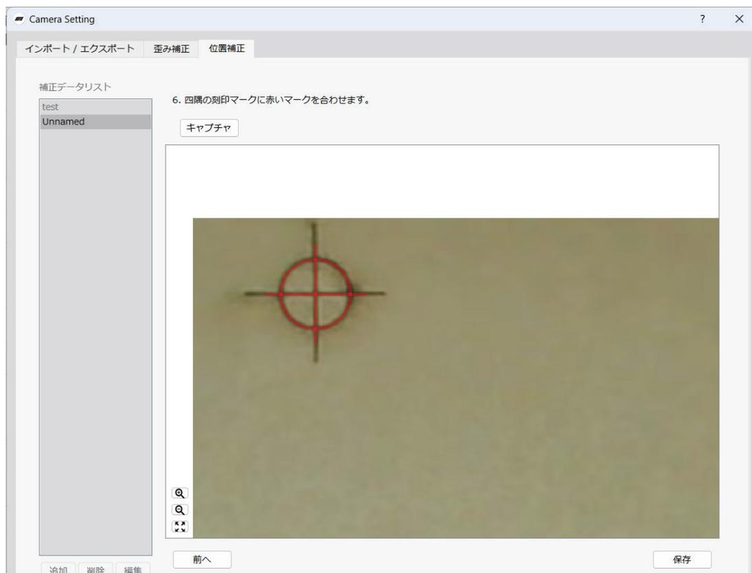
保存をクリックすると、使用する補正データに作成したデータが表示され、カメラの位置補正は終了です。
