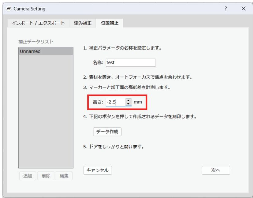
データ作成をクリックすると、ソフトウェアの加工エリアの四隅に位置補正用の赤いマークのデータが表示されます。
