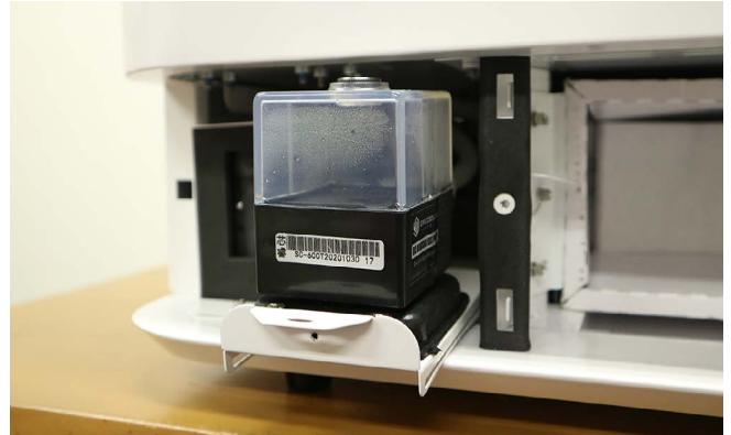
水冷ポンプ上部のネジをマイナスドライバーまたは硬貨で外し、水冷ポンプの8割程度冷却水を入れます。こぼれないようご注意ください。
