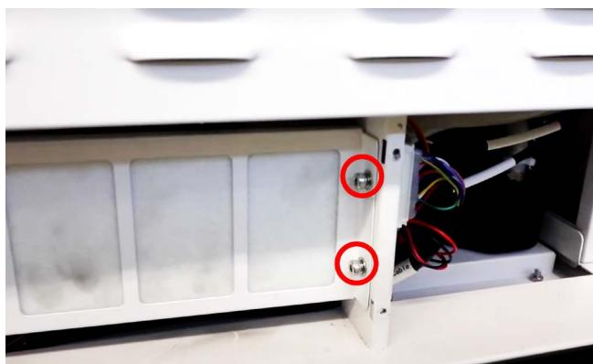
DC ファンのコネクタを基板から取り外します。ケーブルを束ねている結束バンドを切断します。
