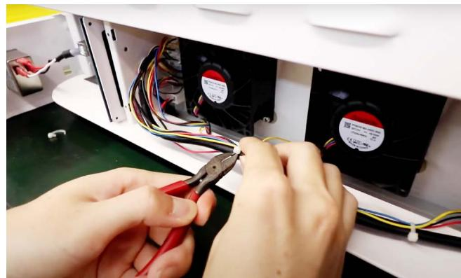
DC ファンを固定している四隅のネジを取り外し、DC ファンを取り外します。DC ファンはアルコールなどを含ませた布等でクリーニングしてください。また、DC ファンの付近も汚れているようであればクリーニングしてください。
