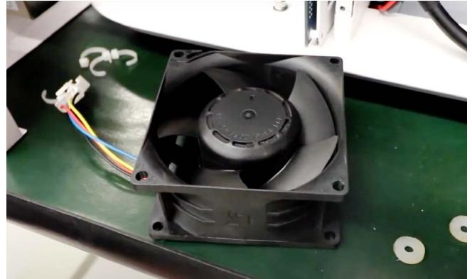
クリーニング後、DC ファン（ゴムのワッシャーを忘れずに使用してください）を取り付けてください。ケーブルがファンにかかるないように下側を通しながらコネクタを接続してください。
