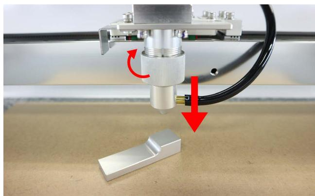
ナットを締めレンズマウントを固定し高さ調整治具を取り出します。これでレーザーヘッドと素材の距離が適正となりました。ナットを締める際、レンズマウントに取り付いているホースが手前になるよう調整し、ホースとX軸が接触しないような位置にしてください。
