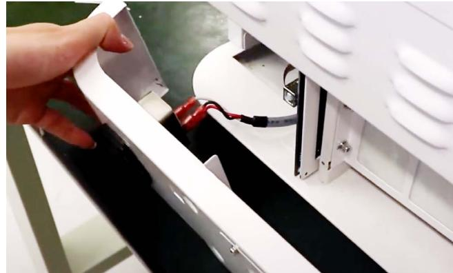
防音プレートを固定しているネジを計 4 つ取り外し、防音プレートを取り外します。
