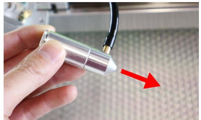
レーザーヘッドの先端をホースに入れ、空気の力で水を排出します。勢いよく水が出る場合があるのでご注意ください。
