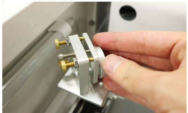
新しいミラーをミラーマウントに取り付け、固定部品で固定します。ミラーがしっかりと入っていないと固定部品が最後まで回らないので、ご注意ください。
