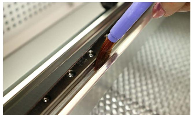
X軸 Y軸すべてに塗ってください。軸以外に油がはみ出した場合は拭き取ってください。塗ったあとに油が馴染むよう、手動でゆっくりと軸を動かしてください。
