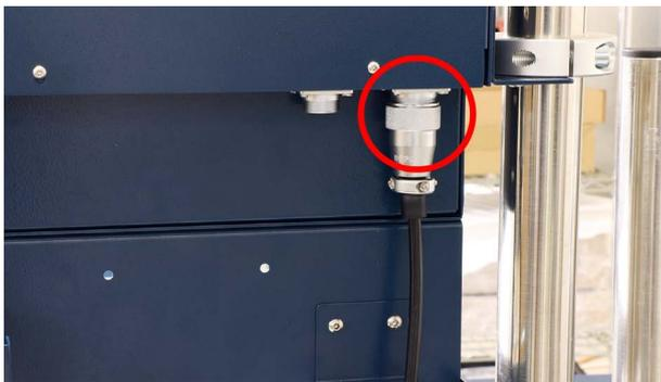
コンソールボックスケーブルをコンソールボックスと電装盤に接続します。
