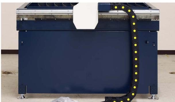
電装盤にケーブルキャリア補助プレートを取り付けます。
