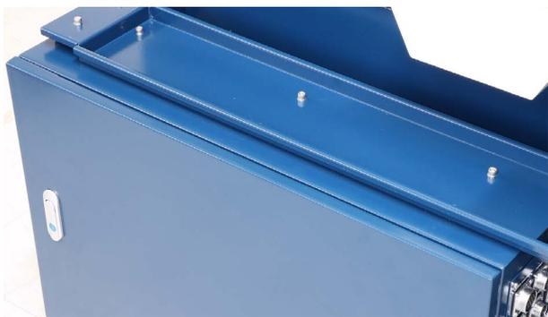
ケーブルキャリア補助プレートをかバー上部のボルトに引っ掛けるように取り付けボルトを締めてください(電装盤が浮いた状態が正常です)。
