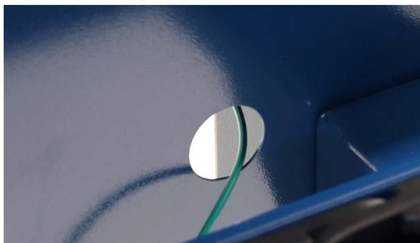
アースクリップをウォーターベッド裏側の写真の位置に取り付けます。アースクリップの反対側もカバーの穴を通してください。
