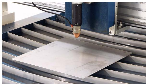
加工を行うためには、トーチ→素材→ウォーターベッド→アースクリップ→プラズマ電源→トーチと導通している必要があるため、導通の確認をします。
