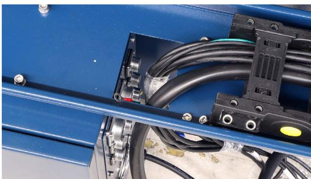
ケーブルキャリア補助プレートに取り付いているボルトとナットを取り外し、ケーブルキャリアを固定します。
