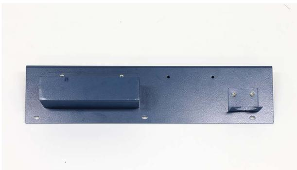
コンソールボックス本体底面のボルトを取り外し、先程組み立てたプレートAを取り付けます。
