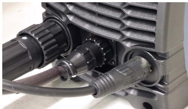
エアコンプレッサーを用意し、プラズマ電源に接続します。付属のホースを使用してください。**エアの推奨供給圧力は0.4-0.6Mpaです。1.0Mpaを絶対に超えないようにしてください。超えた場合、プラズマ電源が破損する恐れがあります。**
