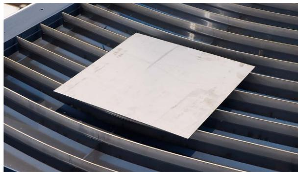
ジョグエリアの「矢印ボタン」もしくはキーボードの「矢印キー」でトーチを操作することが可能です。トーチが素材の真上に来るように調整してください。
