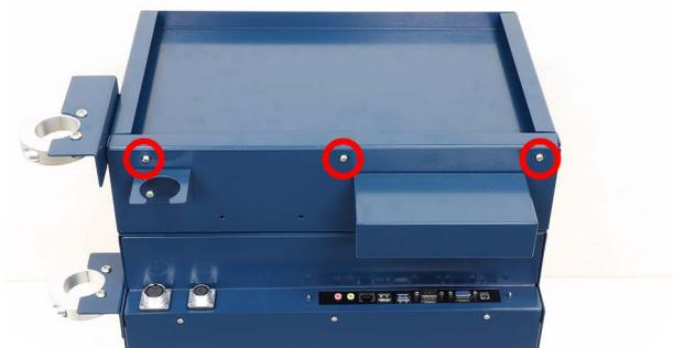
本体正面向かって右側の支柱のボルトを取り外しパイプクランプDを取り付けます。
