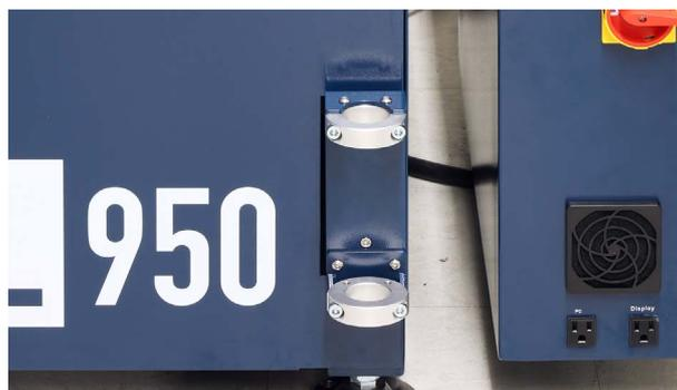
パイプクランプAのボルトを緩めパイプを挿し込みます。ボルトを締めて固定します。
