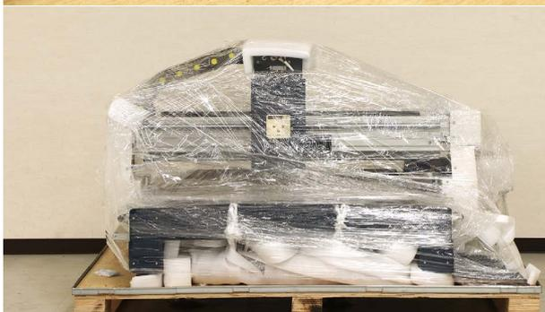
本体を巻いているラップと緩衝材を取り除きます (X軸背面のトーチとコネクタを保護している緩衝材は外さないでください)。
