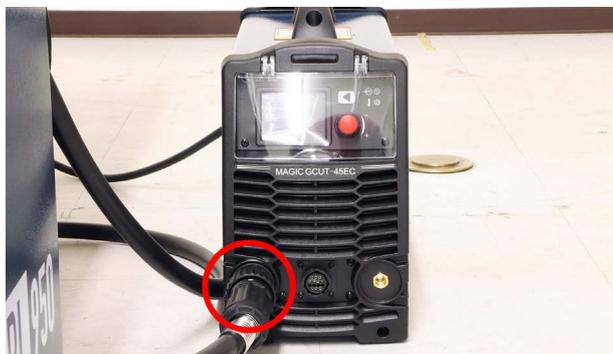
プラズマコントロールケーブルを電装盤とプラズマ電源に接続します。
