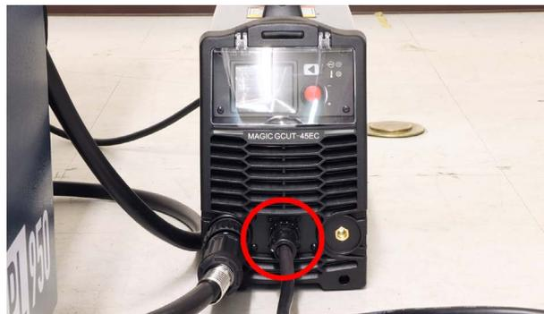
アースクリップをプラズマ電源に接続します。奥まで挿し込みヒネるようにして接続してください。
