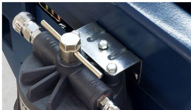
INにエアコンプレッサー、OUTにプラズマ電源を接続してください。
