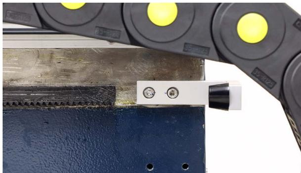
写真の位置にタッチマウントを取り付けます。タッチマウントは磁石で密着します。
