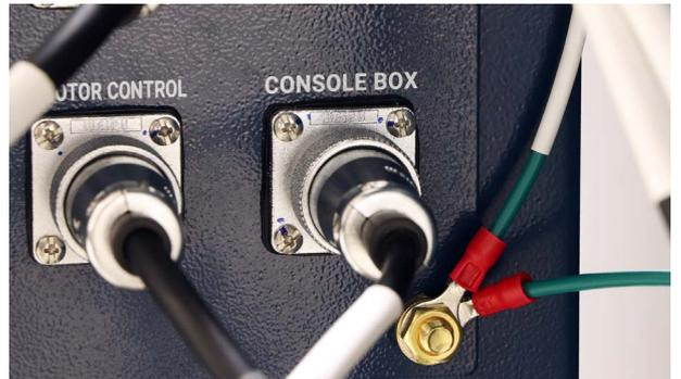
ACアダプタとACケーブルを、コンソールボックス本体と電装盤に接続します。
