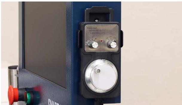
手動コントローラーのケーブルをコンソールボックス本体に接続します。
