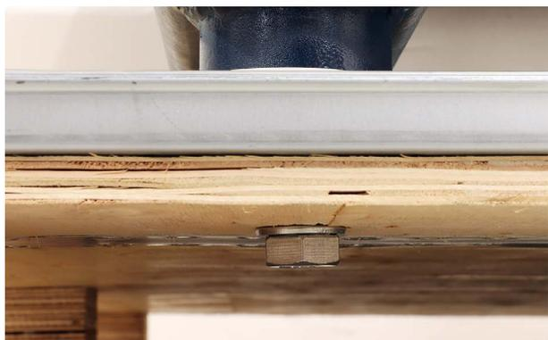
支柱の上部のボルトを六角レンチで取り外します。
