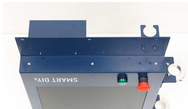
プレートBの側面・背面のボルトを取り外します。
