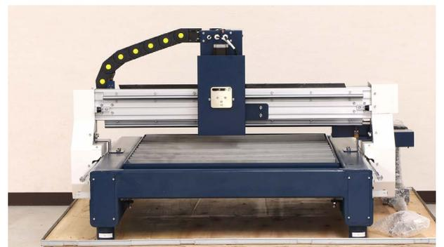
本体の四隅のフタを六角レンチで外します。フタの下部にアルファベットが記載されており、AとCにパレットと本体を固定しているボルトがあります。こちらをモンキーレンチで外します。
