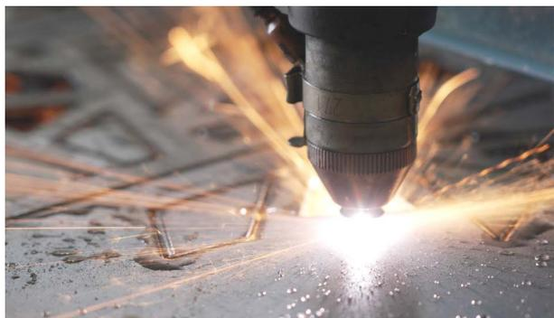
プラズマアークを発生させるためには素材を導通させる必要があります。素材にシートが貼ってあったり塗装やサビの影響で導通しない場合は加工ができません。プラズマ電源→トーチ→素材→ウォーターベッド→プラズマ電源という順序で電気が流れます。
