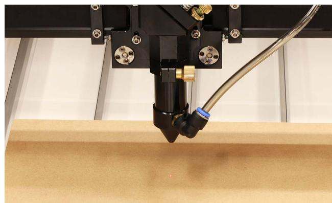
高さ調整治具をレーザーヘッドの真下(素材の上)に置きます。レーザーへッドのネジを緩め、ノズルを高さ調整用治具と接触するまで下げます。
