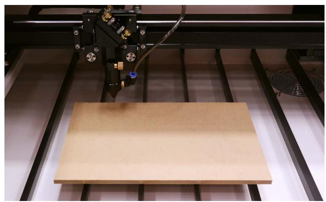
レーザーヘッドに取り付いているネジを回すと、ノズルが上下に動くようになります。板とノズルの間に高さ調整用治具を置き、ノズルを高さ調整用治具に接触させます。レーザーヘッドのネジを締めてノズルを固定します。
