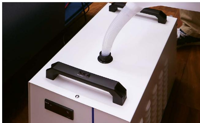
エアーコンプレッサーを箱からだし、電装盤の近くに置きます。付属のエアーホースをエアーコンプレッサーに差し込み、本体の「AIR」に差し込みます。
