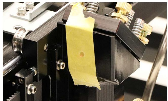
レーザーヘッドを左手前に移動させ、再度レーザーを照射します。このとき、光軸が正しい位置を通りている場合、マスキングテープの焦げ跡の位置が一致しています。
