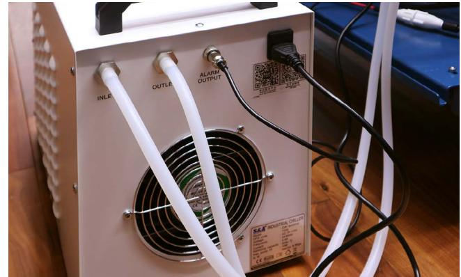
チラーの上部の蓋を開け水を入れます。ペットボトルなどで良いので水を入れる容器を用意してください。計8リットル水を入れます。その後、チラーの電源をONにしてください(この状態では作動しませんが正常です)。
