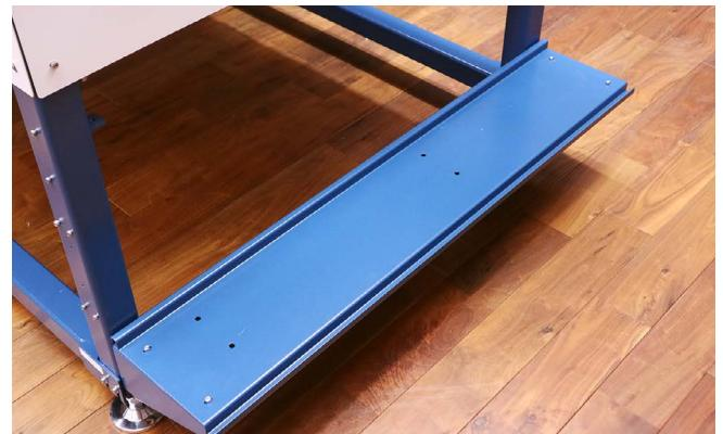
電装盤の台の穴を確認し、電装版を置きます。電装盤の台の下から付属の電装版固定ボルトネジで固定します。
