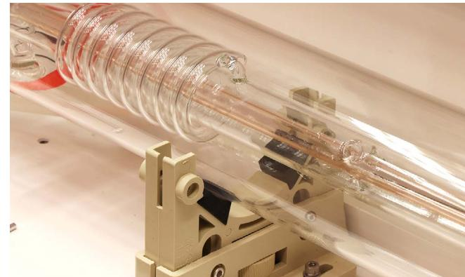
新しいレーザー管と入れ替えます。第1ミラー手前の板から 55mm の位置にレーザー管を設置してください。
