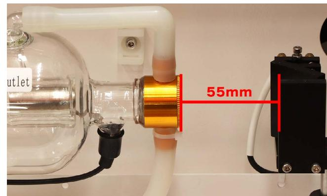
レーザー管マウントでレーザー管を固定します。この時、レーザー管マウント上部を上から押さえつけながら固定してください。
