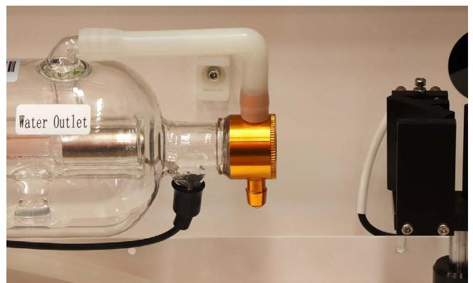
丸栓のボルトを取り外し、レーザー管を固定しているレーザー管マウントの上部を取り外します。
