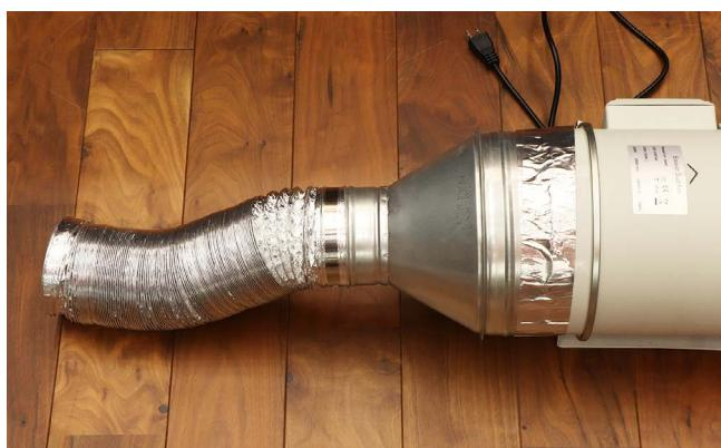
排気ダクト(大)を排気ファンの反対側に取り付けます。ダクトクリップ(大)で固定します。
