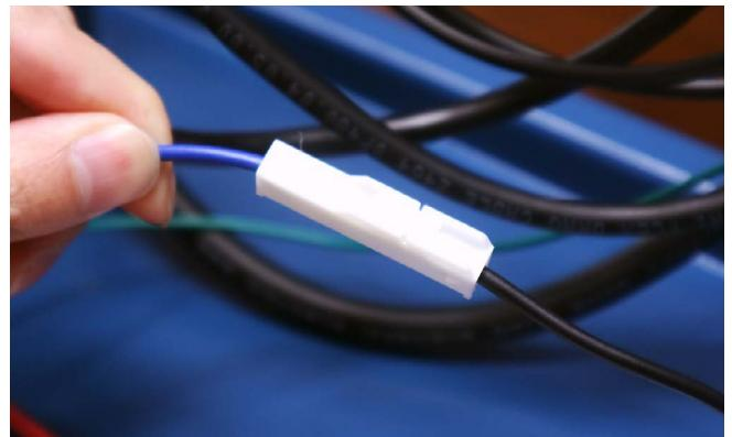
付属の結束バンドを使用してケーブルをまとめます。写真のように、レーザーケーブルとマイナスケーブルは右側、それ以外は左側の結束バンド固定具にまとめます。
