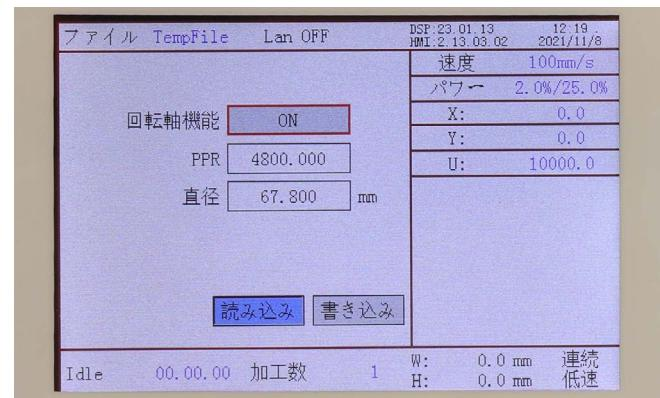
回転軸が正常に動作するかチェックを行います。コントローラーの回転ボタンを押し続けると回転軸のローラーが回ります。回転軸が動作しないようであれば、モータードライバーの接続、コネクタの接続、コントローラーの設定を今一度ご確認ください。
