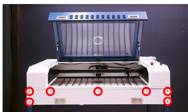
加工ベッドを固定しているボルト（前後5個ずつ、計10個）を取り外し、加工ベッドを手前に引き出します。（加工ベッドの高さによってはブレードが引っかかる場合があります。その際はブレードを取り外してから加工ベッドを引き抜いてください）
