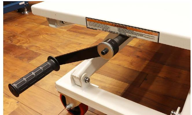
本体の下に昇降リフトを設置しご使用ください。上記写真の方向から見て時計回りが上昇、反時計回りが下降となります。
