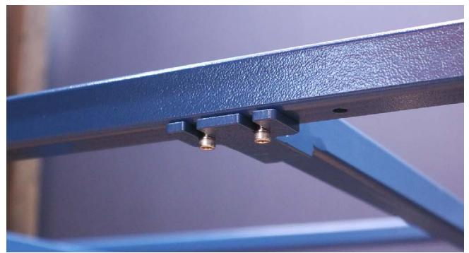
支柱に加工ベッドスライド用フレームを2本取り付けます。
