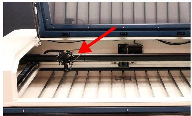
本体のドアを閉め、コントローラーの「レーザー照射」ボタンを押します。レーザーが照射され先程貼り付けたマスキングテープに焦げ跡がつきます。
