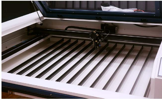
加工ベッドの高さを調整します。支柱の四隅にあるボルト(赤丸)を緩め、長いボルトを締めます。すると加工ベッド(加工ベッド補助フレーム)が上昇します。右の写真のように、加工ベッド補助フレームの爪の中央ラインと赤丸のネジが同じ高さになるように、長いボルトを締めてフレームを押し上げてください。
