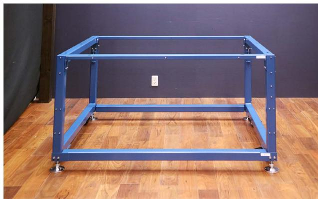
支柱に加工ベッド補助フレーム(横)を2本取り付けます。
