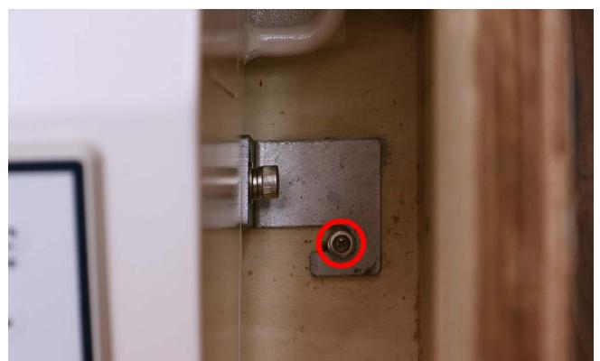
本体の左右の取っ手を持ち架台に載せます。必ず4人以上で行ってください。本体の角と架台の角を合わせてください。本体に取り付いている留め具を取り外します。
