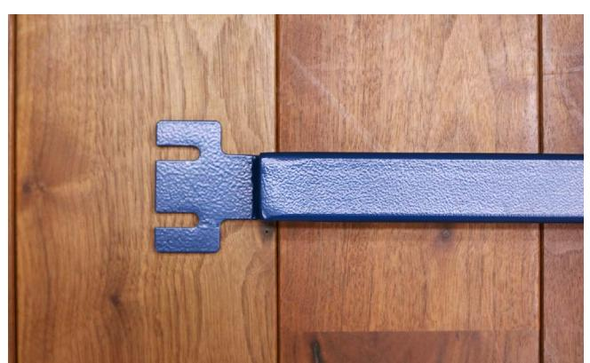
加工ベッド補助フレーム(横)に取り付いているボルトを取り外し、加工ベッド補助フレーム(縦)を取り付けます。
