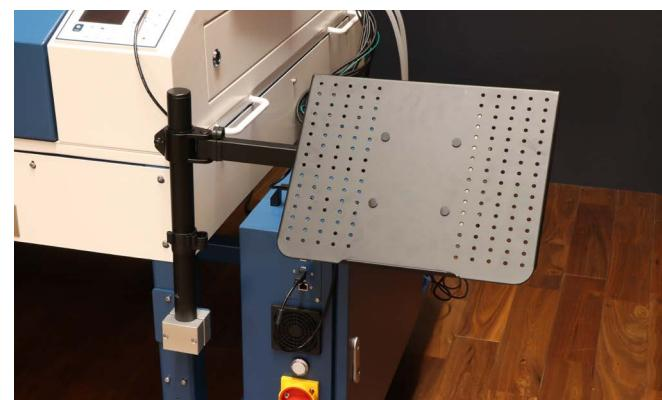
PC台の角度を調整しPCを置いてください。電装盤下部のコネクタからPCに給電することができます。
