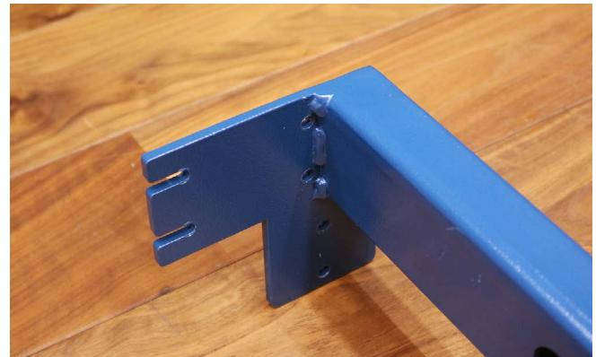
支柱の角のボルトを取り外し(写真の赤丸は取り外し、青丸は緩める)、梁を差し込みます。取り外したボルトで梁を固定します。ボルトは仮止めしてください。
