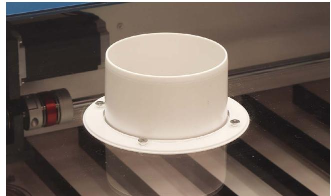
先程排気ファンに取り付けた排気ダクト(小)を、ダクトクリップ(小)で固定します。
