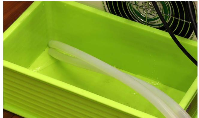
コンプレッサーのACケーブルをコンセントに差し込み、エアーホースを水冷ホースに差し込みます。もう一本の水冷ホースから水が排出されます。水が排出されなくなったらコンプレッサーを止めてください。
