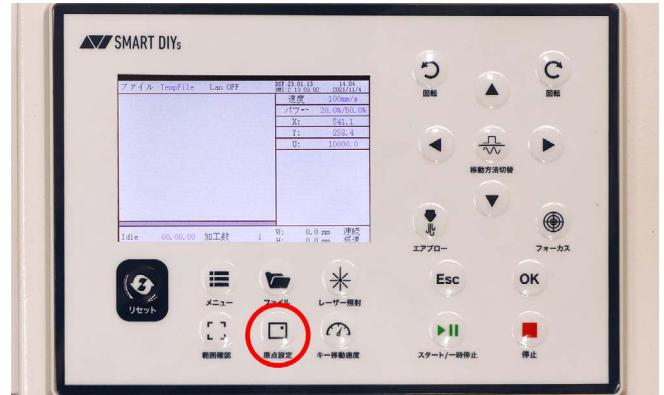
範囲確認ボタンを押すと、レーザーヘッドが縦方向の範囲を示し、回転軸のモーター（素材）が回転することで横方向の加工範囲を示します。位置に問題なければドアを閉めスタートボタンを押すと加工が開始されます（レーザーが照射されるまで時間がかかる場合があります）。
