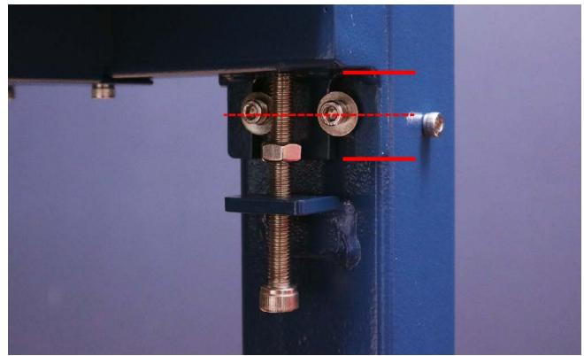
付属の高さ調整治具と、材質は何でも構わないので板をご用意ください。レーザーヘッドを手でゆっくりと左奥に移動させます。レーザーヘッドの下に板を置きます。
