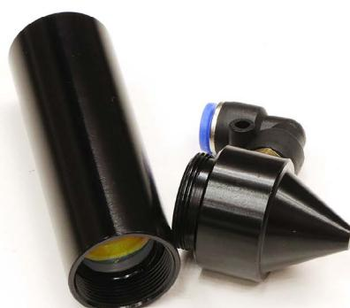
ノズルの中に標準レンズが入っています。レンズを固定している部品(レンズ固定具)を回しレンズを取り出します。レンズ固定具は切掛けがあるのでピンセットなどを使用して取り出してください。レンズはノズルを傾け取り外してください(柔らかい布をご使用ください)。レンズが出てこない場合は綿棒などで逆から押し出してください。
