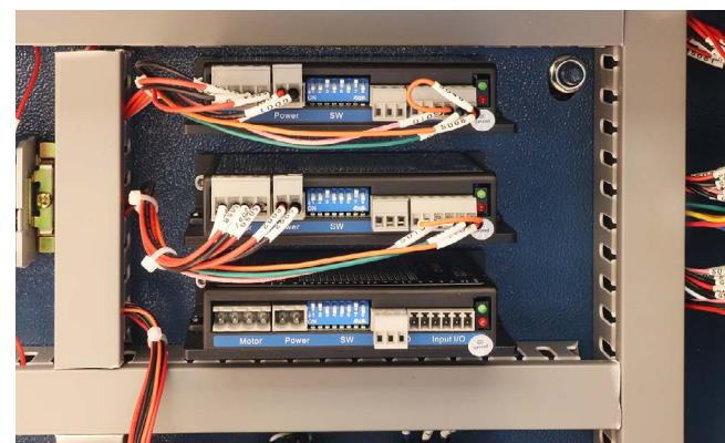
モータードライバーの左からでているケーブルを接続します。接続箇所は写真を参考にしてください。ケーブル接続後、電装盤の扉を閉じてください。
