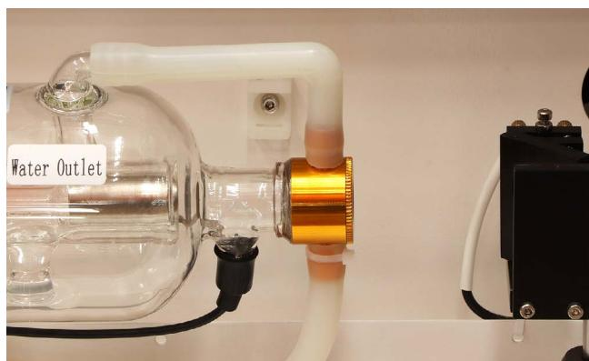
本体背面のカバーを閉め、レーザーケーブルとマイナスケーブルを電装盤に接続します。
