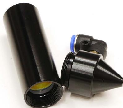
ノズルの中にレンズが入っています。レンズを固定している部品(レンズ固定具)を回しレンズを取り出します。レンズ固定具は切掛けがあるのでピンセットなどを使用して取り出してください。レンズはノズルを傾け取り外してください(柔らかい布をご使用ください)。レンズが出てこない場合は綿棒などで逆から押し出してください。
