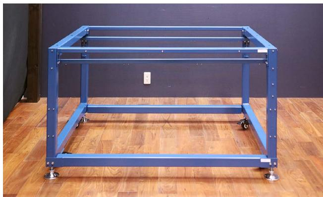
支柱に加工ベッド補助フレーム(縦)を2本取り付けます。
