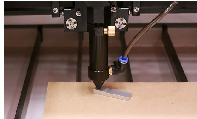
レーザーヘッドを左手前に移動させ、レーザーヘッドの下に板を置きます。ノズルと板の間に高さ調整治具を差し込みます(ノズルの高さは調整しないでください)。このとき、ノズルが高さ調整用治具に接触しない場合は加工ベッドの左下が下がっており、逆に高さ調整用治具が入らないようだったら上がっている、ということになります。
