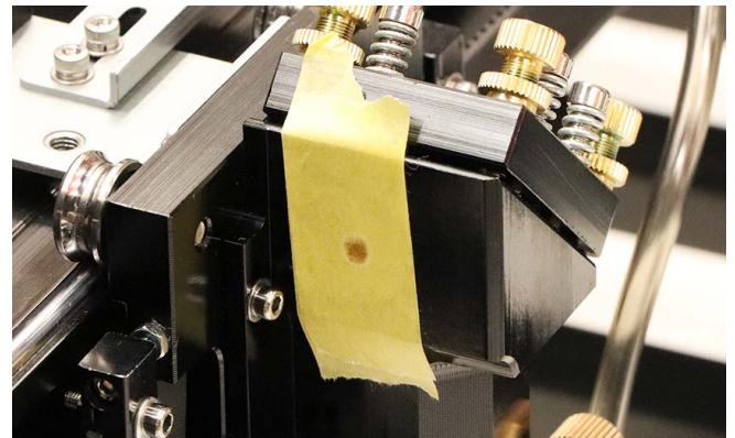
レーザーヘッドを右手前に移動させ、再度レーザーを照射します。マスキングテープの焦げ跡を確認し、一致しているようであれば光軸は問題ありません。
