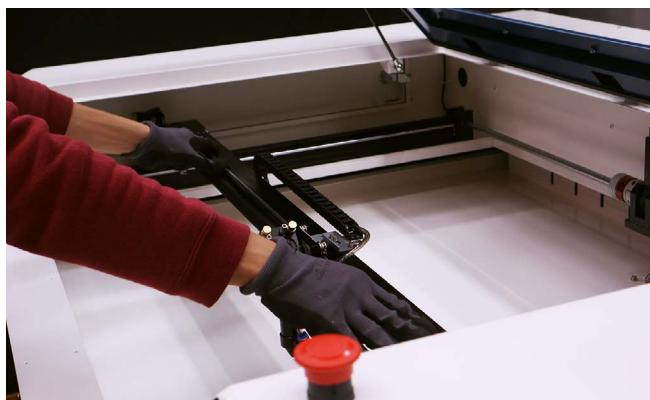
加工ベッドにブレードを取り付けます。ブレードは薄い方を上に向けてください。うまく入らない場合は向きを変えたり、他の溝に入れてください。
