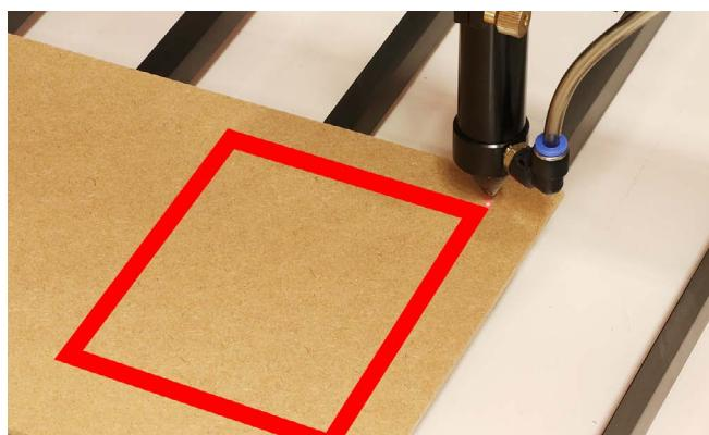
高さ調整を行い、ドアを閉め、スタート/一時停止ボタンを押すと加工が開始されます。
