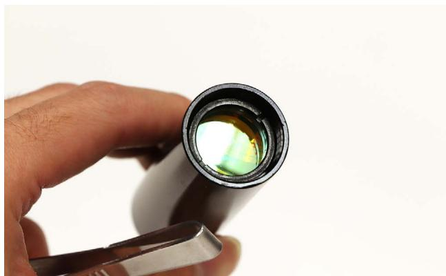
カメラレンズ用のクリーナーなどを使用してクリーニングしてください。ヤニなどは落ちにくいため、レンズに傷が付かないように気を付けながら、何度も拭いて落としてください。
