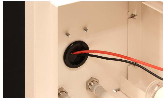
レーザーケーブルとマイナスケーブルを固定している結束バンドを切断します。
