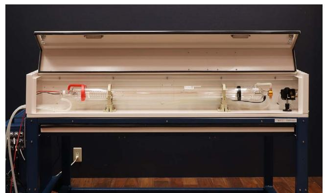
写真赤丸のナットをペンチ(スパナ)で緩め、カバーを取り外します。レーザーケーブルとマイナスケーブルをレーザー管側に引き抜いてください。
