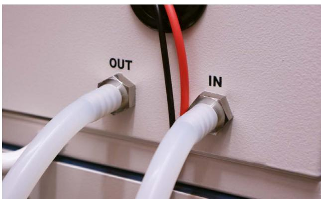
付属の水冷ポンプケーブルとACケーブルをチラーと電装盤(WATER PUMP)に接続します。
