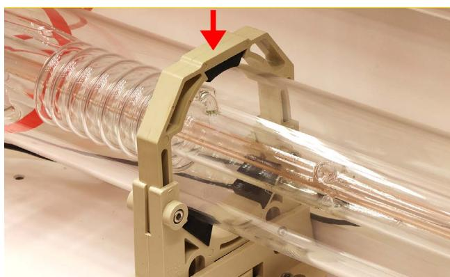
水冷ホースをレーザー管に取り付けます。
