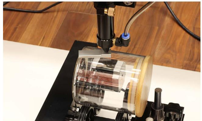
再度コントローラーの矢印ボタンを使用して、加工を開始したい位置にレーザーヘッドを移動させます（素材のどこの高さに加工を行うかを決める。下記写真の場合、現在のレーザーヘッドの位置から赤線で示した範囲へ加工される）。ここで原点設定ボタンを押して、加工の開始点を設定します。
