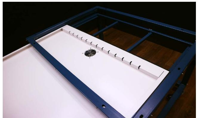
先程加工ベッドから取り出したボルトで、加工ベッドと加工ベッド補助フレームを固定します。すべてのボルトを少しづつ締めてください。加工ベッド取り付け後、さきほど仮止めしたネジをすべて増し締めします。
