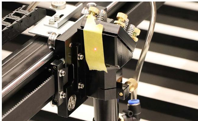
コントローラーの「矢印」ボタンを押すとレーザーヘッドが移動します。レーザーヘッドを左奥に移動させます。
