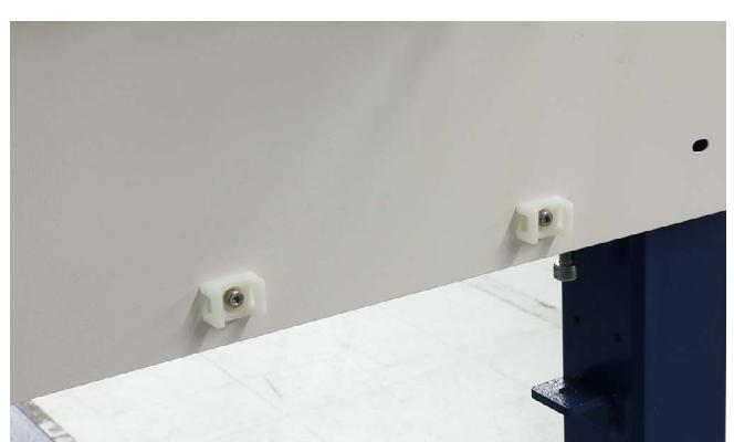
電装盤の台を取り付けます。本体向かって左側の支柱のボルトを緩め、電装盤の台を取り付けます。取り付け後、ボルトを締めてください。
