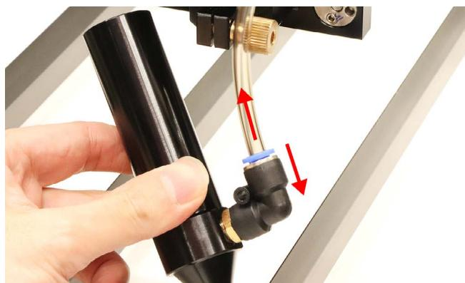
ノズルの先端を回すことで先端を取り外すことができます。
