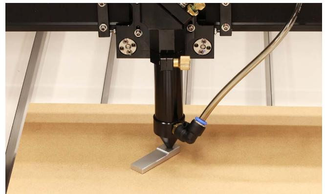
ネジを締めノズルを固定し高さ調整治具を取り出します。これでレーザーへッドと素材の距離が適正となりました。ネジを締める際、ホースノズルが手前に来ているとX軸を一番手前に移動した際に加工機と接触する可能性があるため、位置を調整してください。
