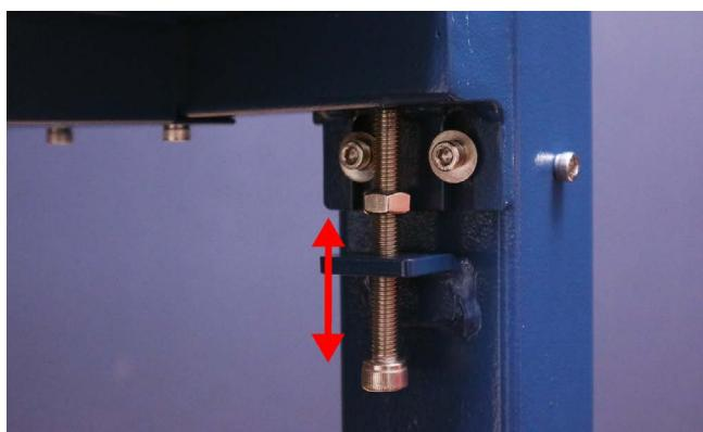
調整後、写真の赤丸のナットを締めて固定します。このとき、長いボルトを六角レンチで固定しながら締めてください。その後、青丸のボルトを締めてください。
