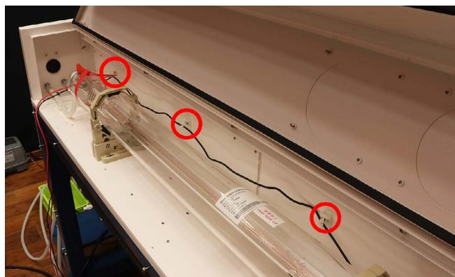
レーザー管に繋がっている水冷ホースの結束バンドを切断し、水冷ホースを引き抜いてください。レーザー管はガラス製のため慎重に行ってください。
