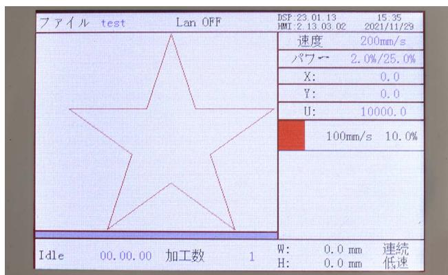
先程設定したパラメータが赤枠部分に表示されます(スピードの単位はmm/sに変換されます)。コントローラーではスピードとパワーのみ変更することができます。メイン画面にてOKボタンを押し、矢印ボタン(下)を押すことで赤枠部分を選択することができます。赤枠部分でもう一度OKボタンを押すとパラメータの設定ができます。
