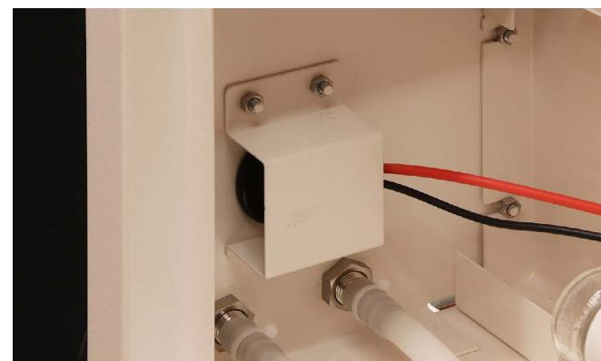
結束バンドで、レーザーケーブルとマイナスケーブルを3箇所、水冷ホースを2箇所固定します。固定後、結束バンドの不要な部分をニッパーで切断してください。
