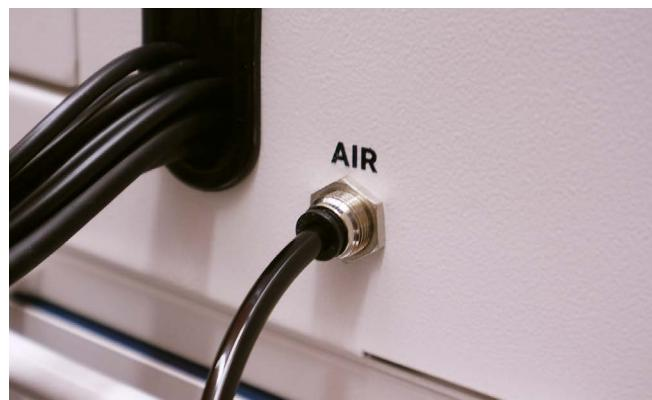
エアーコンプレッサのACケーブルを電装盤に差し込みます。
