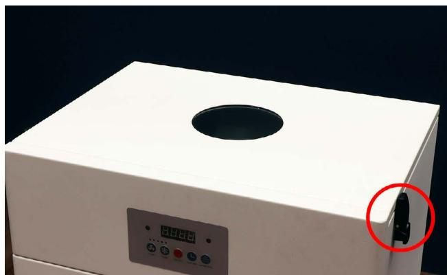
ダクトをダクトクリップ (ダクト取付済み) を使用し集塵機の背面にある吸気口に取り付けます。吸排気口は2箇所ありますが、上が吸気口、下が排気口です。ダクトは長短どちらを使用しても構いませんが、集塵機を本体近くに置く場合は短いダクトの使用をおすすめします。
