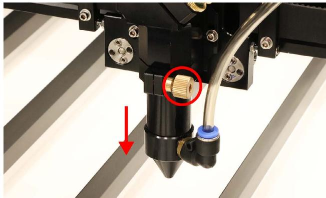
ノズルにつながっているホースを取り外します。ホースが差し込まれている青い部分を押しながら、ホースを引き抜きます。
