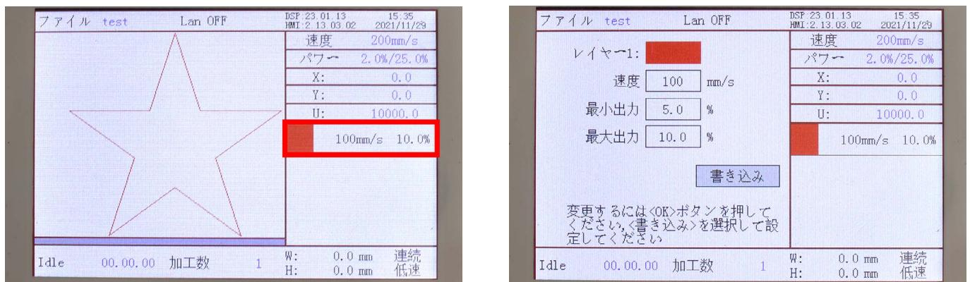
素材をセットし、コントローラーの矢印ボタンで任意の場所にレーザーヘッドを移動させます。その後、原点設定ボタンを押すと、現在のレーザーヘッドの位置が原点(データの右上)として設定されます(写真の赤枠の範囲にデータが加工されます)。範囲確認ボタンを押すと、レーザーヘッドがデータの外周を移動するので、素材の位置の調整、または原点の位置を調整してください。
