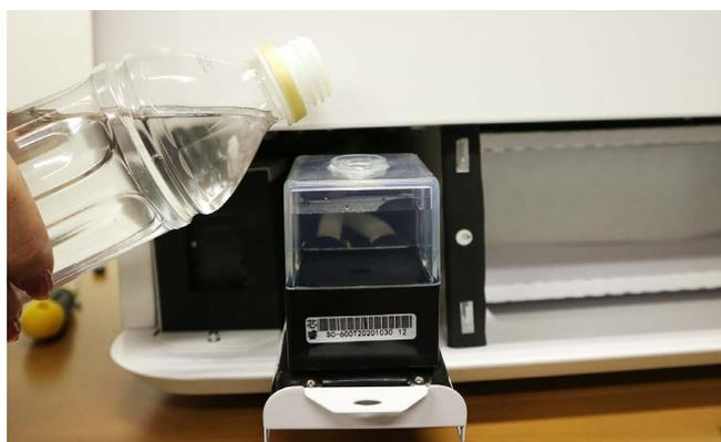
本体背面の電源スイッチをオンにしてください。ライトが点灯し、水冷ポンプ内の水が本体全体を循環し始めます。水冷ポンプ内の水が減っていくので水を継ぎ足してください。※最初は気泡が多くですが徐々に減っていき水位が安定してきます。
