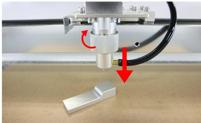
ナットを締めレンズマウントを固定し高さ調整治具を取り出します。これでレーザーヘッドと素材の距離が適正となりました。ナットを締める際、レンズマウントに取り付いているホースが手前になるよう調整し、ホースとX軸が接触しないような位置にしてください。
