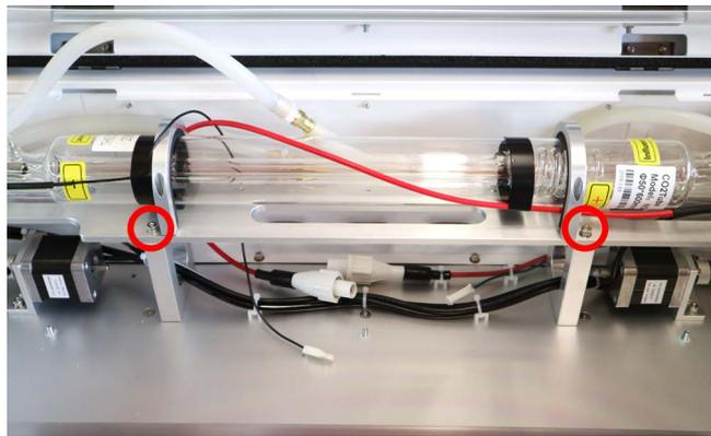
背面の窓のネジ3箇所をプラスドライバーで外し、丸印のネジ2箇所を六角レンチで取り外してください。
