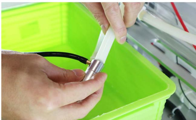
水が排出されなくなったらエアコンプレッサーを OFF にし、電源を切ってください。水を完全に抜ききることはできないため、ある程度レーザー管の中に水が残っていても問題ありません。※水の入れ替えのみを行う場合は、ホースをコネクタに取り付け、水冷ポンプから水を入れてください。
