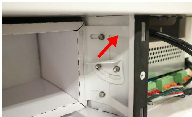
集塵ボックスを引き抜きます。集塵ボックスは集塵フィルタが計4種類入っています。
