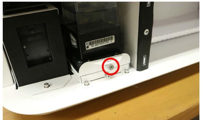
向かって左側面にある窓をドライバーで外し、水冷ポンプにつながっているホースが折れ曲がっていないか確認します。折れ曲がっている場合は手でホースの位置を調整してください。
