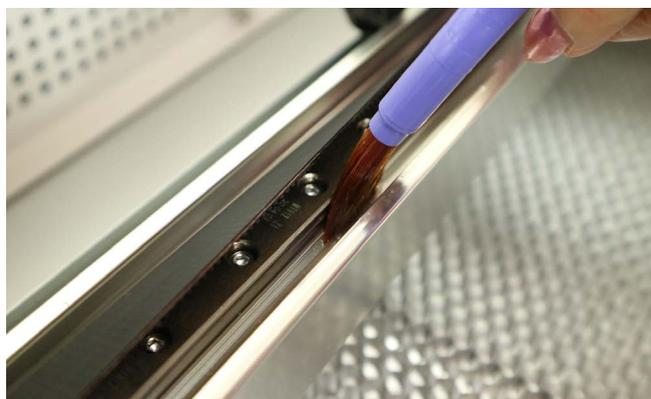
X軸Y軸すべてに塗ってください。軸以外に油がはみ出した場合は拭き取ってください。塗ったあとに油が馴染むよう、手でゆっくりと軸を動かしてください。
