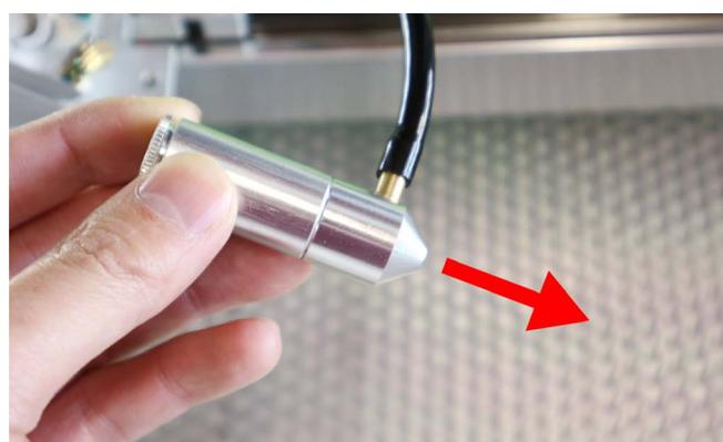
レーザーヘッドの先端をホースに入れ、空気力で水を排出します。勢いよく水が出る場合があるのでご注意ください。
