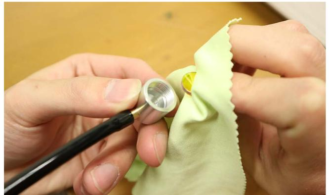
レンズを固定する部品を取り付けます。きつく締めすぎるとレンズが破損するのでご注意ください。
