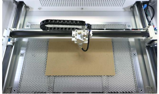
高さ調整治具をレーザーヘッドの真下（素材の上）に置きます。レーザーヘッドのナットを緩め、レンズマウントを高さ調整治具と接触するまで下げます。※レンズマウントが固く動かしづらい場合がありますが正常です
