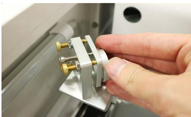
新しいミラーをミラーマウントに取り付け、固定部品で固定します。ミラーがしっかり入っていないと固定部品が最後まで回らないので、ご注意ください。
