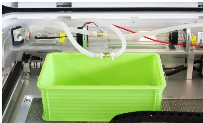
ホースはコネクタで接続されており、一方はレーザー管と、もう一方は本体下部に繋がっています。本体下部に繋がっている方の結束バンドをニッパーで切断し、コネクタからホースを抜いてください。ホースを抜くと若干水が出てきます。この状態で電源を入れてください。更に水が出てきます。
