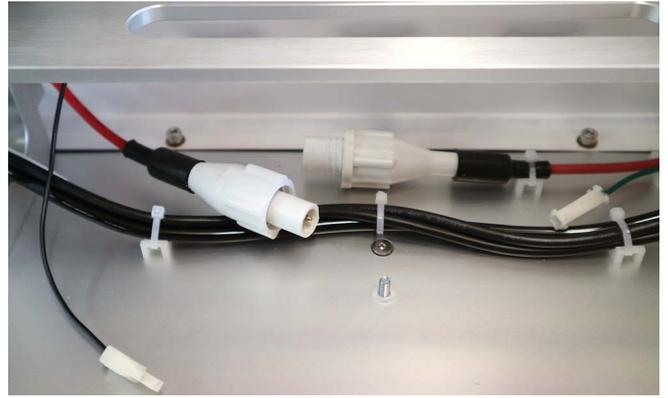
レーザー管を取り外します。レーザー管を固定しているマウントごと外すので、写真の丸印のネジ2箇所を六角レンチで取り外してください。
