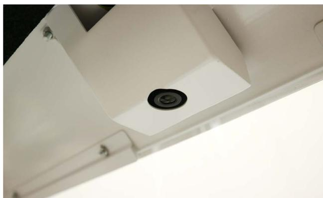
加工ベッドに付いている位置調整用マークが削れたり汚れたりした場合カメラ機能が使えなくなります。その場合、付属の位置調整用シールを上から貼り付けてください。
