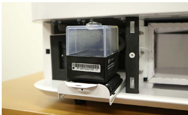
水冷ポンプ上部のネジをマイナスドライバーまたは硬貨で外し、水冷ポンプの8割程度水を入れます。こぼれないようご注意ください。
