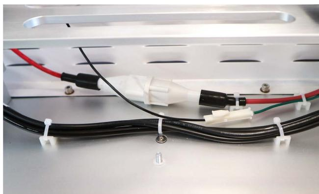
レーザー管に繋がっているホースの片方（向かって右側）をコネクタから抜き、本体下部からでているホース（コネクタが付いている方）につなげます。もう片方のホースもつなげてください。
