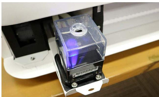
水が全体に循環しているか確認します。レーザー管付近のホースが折れ曲がっていないか（白い半透明の管がホースです）、ホースやレーザー管内に大きな気泡がないか確認してください。大きな気泡がある場合はホースを揺する、または電源を入り切りすることでポンプの動作も入り切りできるので何回か繰り返し気泡を取り除いてください（小さい気泡は問題ありません）。水位が安定したあとも3分程度はそのままにし、その後電源を切ってください。
