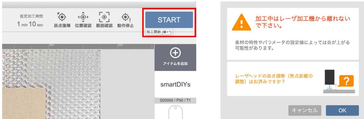
すべての準備が終了しました。ドアを閉めて「START」をクリックしてください。注意点が表示され、高さ調整など問題がなければ「OK」をクリックしてください。加工が開始されます。
