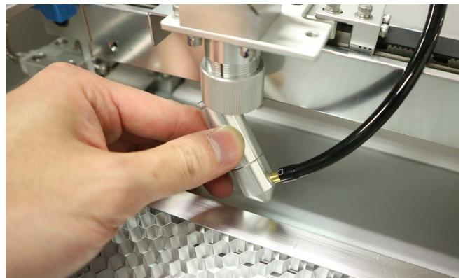
レンズマウントを固定しているナットを緩め、レンズマウントを引き下げます。
