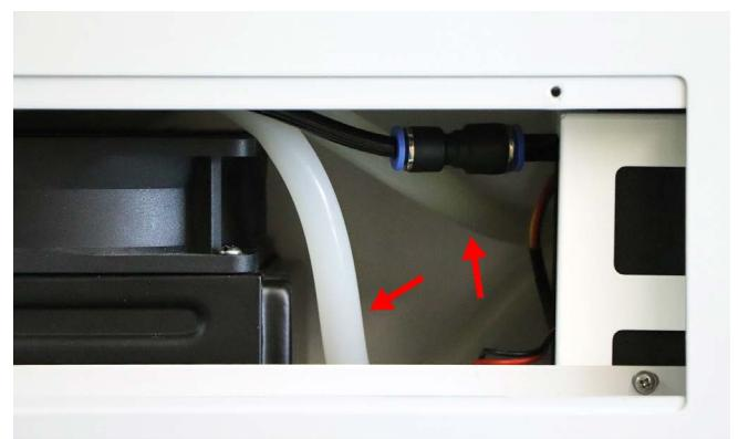
窓をもとに戻し、取り外していた本体下部のカバーを取り付けネジで固定してください。カバー裏の切掛け部分が向かって右側に来るよう取り付けます。
