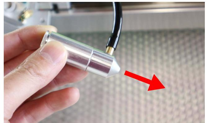
レーザー頭の先端をホースに入れ、空気の力で水を排出します。勢いよく水が出る場合があるのでご注意ください。
