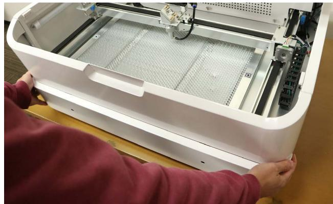
本体内部奥のネジを取り外し、レーザー管カバーを取り外します。カバー上部にツメが付いているので注意しながら引き上げてください。X 軸が邪魔な場合は、両手で X 軸を持ちゆっくりと手前に動かしてください。
