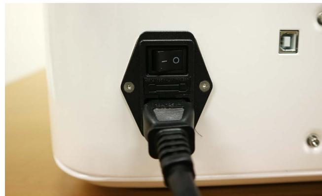
AC ケーブルを壁のコンセントに接続してください。※電源はまだオンにしないでください。※ AC ケーブルは 3 ピンになります。3 ピン用コンセントに挿し込んでいただくか、不可能な場合は変換アダプタを使用してアース接続を行ってください。※ Etcher Laser Pro の使用電力は約 750W となるので、多数口タイプではなく 1 個口タイプの延長コードを推奨します。
