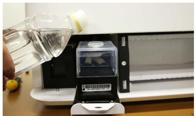
本体背面の電源スイッチをオンにしてください。ライトが点灯し、水冷ポンプ内の水が本体全体を循環し始めます。水冷ポンプ内の水が減っていくので水を継ぎ足してください。※最初は気泡が多くでますが徐々に減っていき水位が安定してきます。
