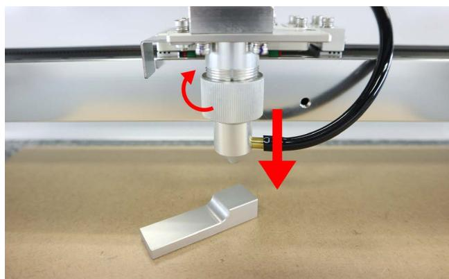
ナットを締めレンズマウントを固定し高さ調整治具を取り出します。これでレーザーheadと素材の距離が適正となりました。ナットを締める際、レンズマウントに取り付いているホースが手前になるよう調整し、ホースとX軸が接触しないような位置にしてください。
