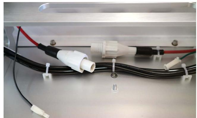
レーザー管を取り外します。レーザー管を固定しているマウントごと外すので、写真の丸印のネジ4箇所を六角レンチで取り外してください。
