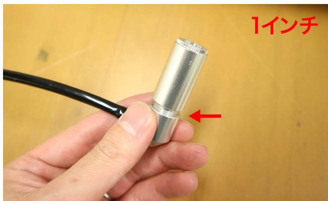
レンズマウントを取り外します。2インチレンズ（標準レンズ）と1インチレンズで、レンズを取り付ける箇所が異なります。2インチレンズの場合はレンズマウント上部の部品を緩め、1インチレンズの場合はレンズマウント
