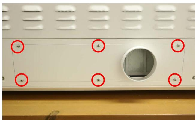
排気ダクトにダクトクリップを取り付けます。マイナスドライバーでダクトクリップのネジを緩めると、ダクトクリップの直径が大きくなるので調整して取り付けてください。
