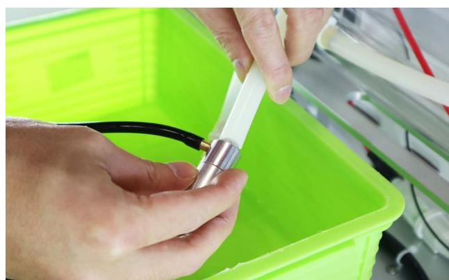
水が排出されなくなったらエアーコンプレッサーを OFF にし、電源を切ってください。水を完全に抜ききることはできないため、ある程度レーザー管の中に水が残っていても問題ありません。※水の入れ替えのみを行う場合は、ホースをコネクタに取り付け、水冷ポンプから水を入れてください。
