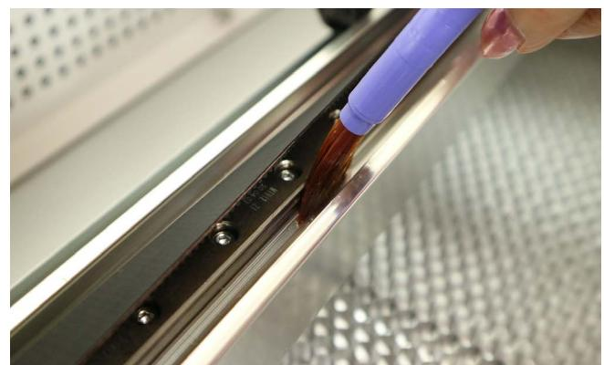
X 軸 Y 軸すべてに塗ってください。軸以外に油がはみ出した場合は拭き取ってください。
