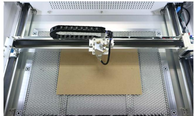
高さ調整治具をレーザーheadの真下（素材の上）に置きます。レーザーheadのナットを緩め、レンズマウントを高さ調整治具と接触するまで下げます。※レンズマウントが固く動かしづらい場合がありますが正常です
