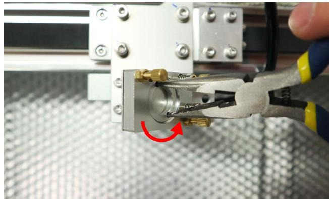
レンズを固定している丸い固定部品を回して取り外します。ミラーマウントの裏側にある長いネジは触らないでください。
