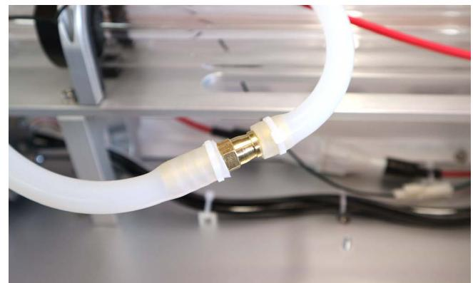
ホースをレーザー管奥に押し込み（ホースが折れ曲がらないようご注意ください）、[冷却水の注入作業](#)を行ってください。
