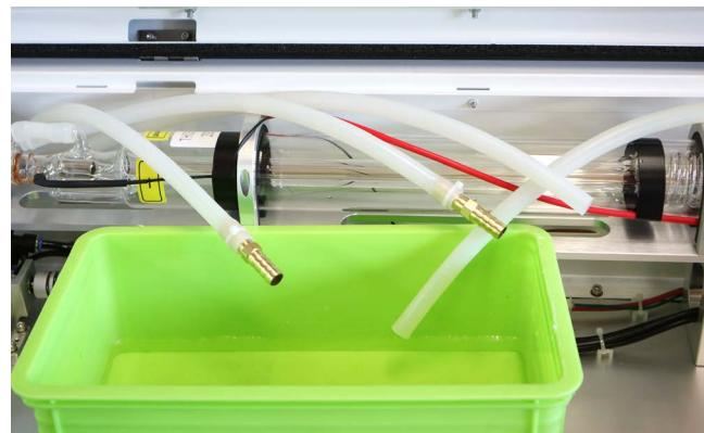
レーザー管下部にある2本のケーブルを外します。緑と黒のケーブルは突起部分を押しながら外してください。
