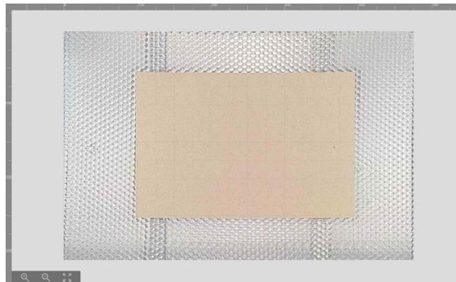
「位置確認」をクリックします（位置確認モード）。グラフィックエリア（写真が表示されたエリア）の左上にレーザーヘッドのイラストが表示されます。このイラストをドラッグすることで、レーザーヘッドを任意の位置に移動させることができます。この機能を使い、レーザーヘッドを素材の真上に移動させます。
