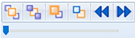
選択した図形の加工順序を、最初へ移動、最後へ移動、一つ前へ移動、一つ後ろへ移動といった調整が可能です。また、任意の図形を選択し、前の図形（◀◀）または次の図形ボタン（▶▶）をクリックすると、選択した図形の前後の処理順序を確認できます。
