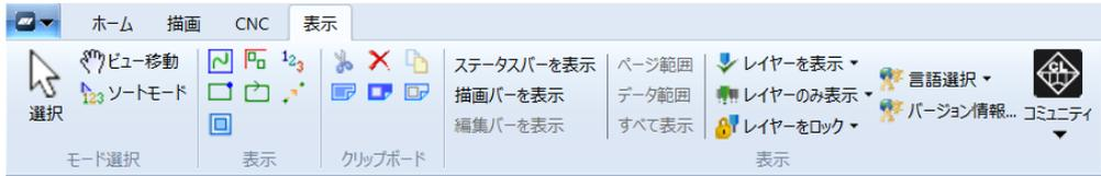
このツールバーでは、インターフェースの表示に関する各種機能を操作できます。主な機能として、グラフィック画面の操作モードの切り替え、描画バーやステータスバーの表示・非表示の切り替え、レイヤーの表示・非表示・ロックなどがあります。
