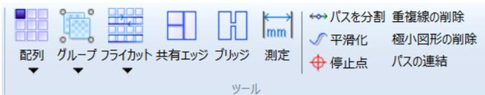
ツールは、図形の加工を補助する機能であり、加工効率の向上や特定の機能要件を満たすことを目的としています。主な機能として、配列、グループ化、スキャン、共通エッジ処理、ブリッジ、測定、曲線分割、自動ブリッジ、重複線の削除、小さなグラフィックの削除、接続線の結合などがあります。これらの機能を活用することで、作業の精度を向上させ、加工の工程を最適化することができます。
