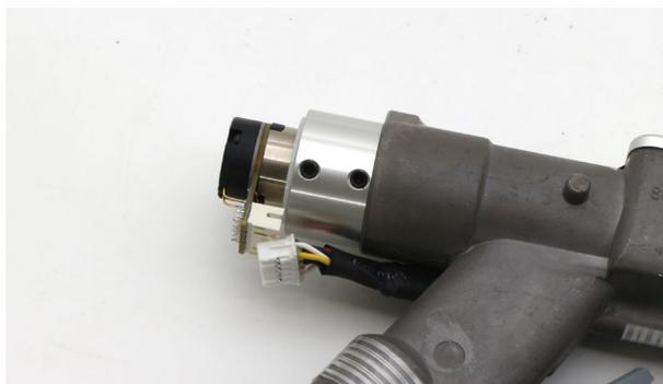
写真赤丸のイモネジを緩め、反射ミラーを引き抜きます。
