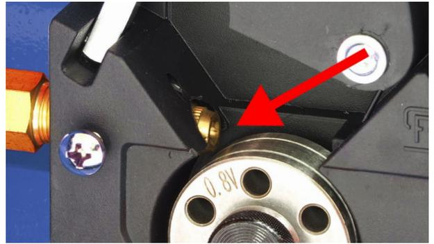
ワイヤーケーブルの反対側にワイヤーケーブル固定具を取り付けます。
