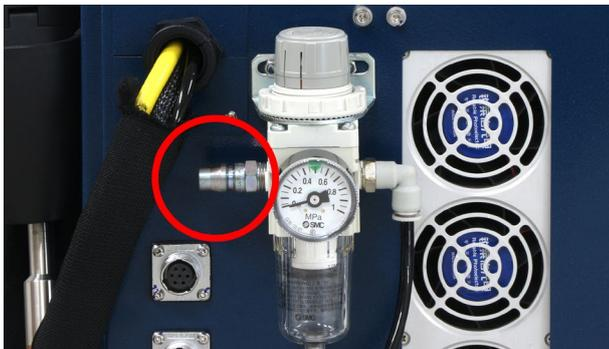
矢印部分を上に引っ張り回転させることで圧力の調整が可能です。アシストガスは、窒素もしくはアルゴンガス（ステンレスの欠陥を軽減させるためアルゴンガス推奨）を使用し、流量は15～20L、圧力は0.2Mpaを推奨しています。
