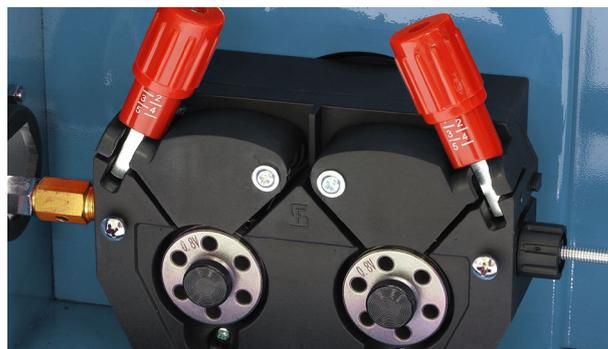
赤いレバーは加圧ハンドルとなっています。ハンドルを回し、ワイヤーの直径に応じた加圧量にしてください。左右同じ加圧量にしてください。
