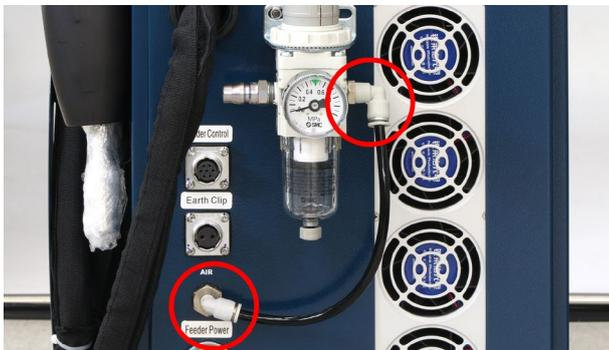
ガスのホース（ハイカプラ）をガスレギュレーターに接続してください。
