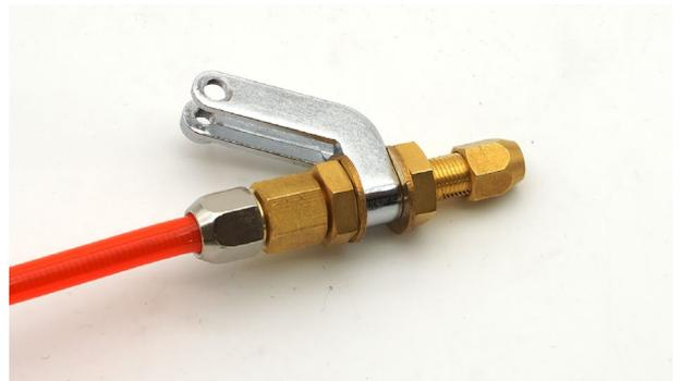
ワイヤーケーブル固定具を写真のようにトーチに取り付け、M5ボルトで固定します。
