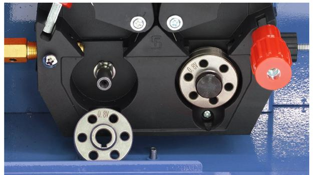
ワイヤー供給ノズルを取り外し、ワイヤーの直径に対応したノズルを準備します（取り付けはしないでください）。
