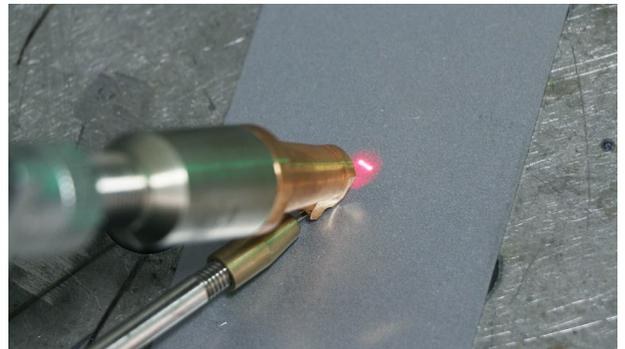
問題なければ溶接を開始します。「照射有効」をオンにし、トーチを母材に接触させ、トーチのボタンを押すことでレーザーが照射されます。「照射有効」がオンのままパラメータ編集画面などに遷移してもレーザーは照射可能な状態です。溶接時以外はかならず「照射有効」をオフにしてください。
