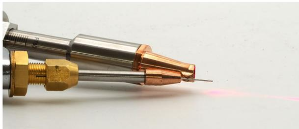
ワイヤーを母材に軽く押し当て、レーザーポインターがワイヤーに照射されているか確認します。ワイヤーがずれているようであれば、ノズル固定具のナットを緩め、ノズルを少し回転させながら溝の位置を微調整することでワイヤーの位置も調整できます。また、タッチパネルの設定でレーザーの照射位置を調整することも可能です。詳細は [P35の中心位置調整](#) をご覧ください。
