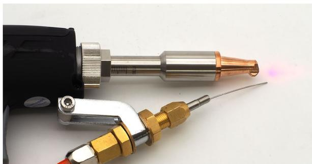
ストッパーを取り外し、ワイヤーをセットします。写真赤丸のピンにワイヤーの穴がはまるようにしてください。セット後、ストッパーを取り付けてください。
