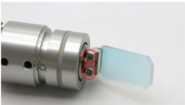
新しい反射ミラーを取り付け固定します。固定位置はコネクタと同じ向きとなるように調整してください。
