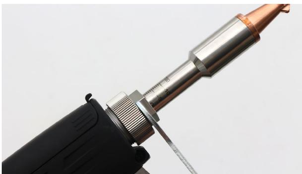
ナットの先端にノズル固定具のメモリが0となるように調整します。
