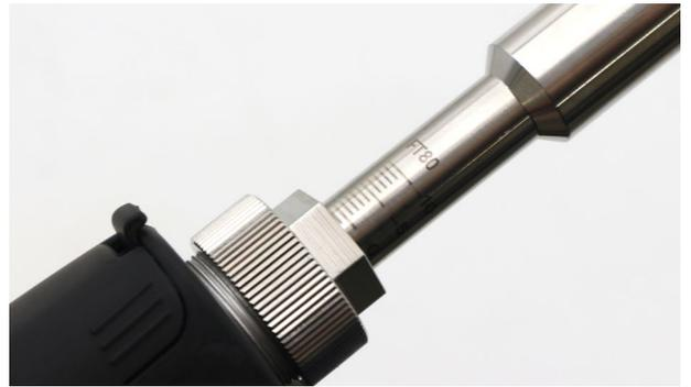
レーザーを照射しながら調節します。パラメータを調整し、なるべく低いエネルギーでテストします。パワー:10%、デューティ比:10%、照射モード:点、後はデフォルトです。
