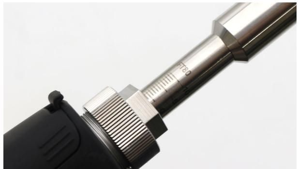
レーザーを照射しながら調節します。パラメータを調整し、なるべく低いエネルギーでテストします。パワー：150W、デューティー比：10%、照射モード：点、後はデフォルトです。
