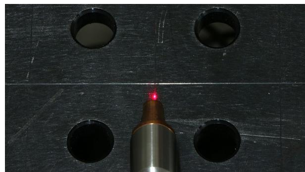
まずは横方向の位置を調整します。先ほど取り付けた反射ミラーを回転させ、レーザーpointerが中心にくる箇所でイモネジで固定します。
