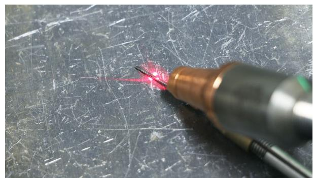
トーチの先端を母材に接触させ、タッチパネルの導通ランプが点灯していることを確認してください。導通ランプが点灯していない場合は11. トラブルシューティングをご確認ください。
