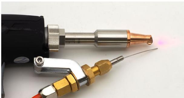
ストッパーを取り外し、ワイヤーをセットします。写真赤丸のピンにワイヤーの穴がはまるようにしてください。セット後、ストッパーを取り付けてください。
