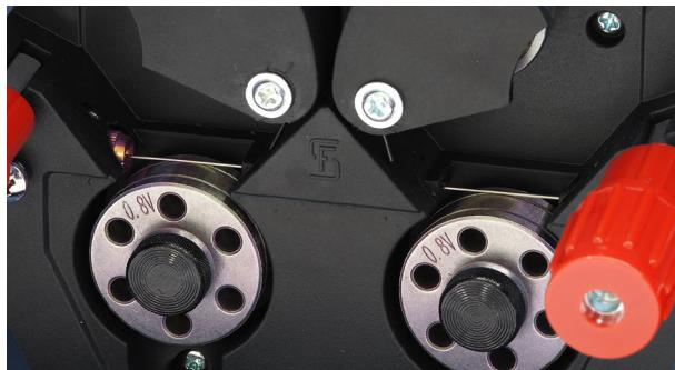
ワイヤーを挟み込む部品を下にさげ、赤いレバーを上にあげて固定します。
