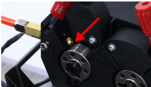
ワイヤーケーブルの反対側にワイヤーケーブル固定具を取り付けます。ワイヤーケーブル固定具はトーチから取り外してください。
