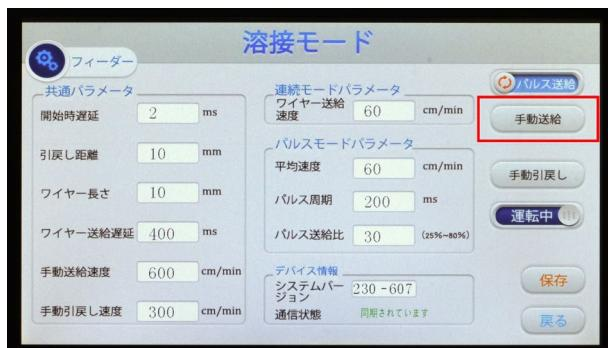
そのまま送給を行いワイヤーがトーチまで到達したら、ワイヤーノズル（短いノズル）とワイヤー送給ノズル（ワイヤーの直径に合わせたノズル）を取り付けます。ワイヤー固定具の途中でワイヤーが引っかかる場合は、ノズルの位置を調整してワイヤーを送給してください。
