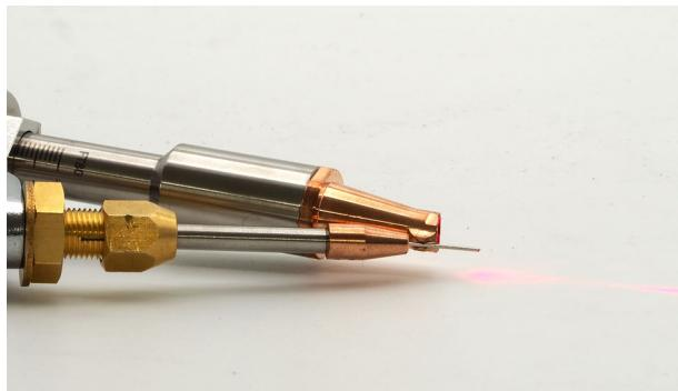
ワイヤーを母材に軽く押し当て、レーザーポインターがワイヤーに照射されているか確認します。ワイヤーがずれているようであれば、ノズル固定具のナットを緩め、ノズルを少し回転させながら溝の位置を微調整することでワイヤーの位置も調整できます。また、タッチパネルの設定でレーザーの照射位置を調整することも可能です。詳細は [P42の中心位置調整](#)をご覧ください。
