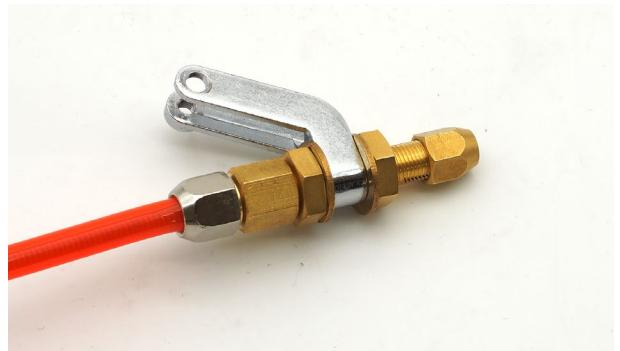
ワイヤーケーブル固定具を写真のようにトーチに取り付け、先ほど取り外したboltで固定します。
