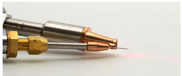
ワイヤーを母材に軽く押し当て、レーザーpointerがワイヤーに照射されているか確認します。ワイヤーがずれているようであれば、ノズル固定具のナットを緩め、ノズルを少し回転させながら溝の位置を微調整することでワイヤーの位置も調整できます。また、タッチパネルの設定でレーザーの照射位置を調整することも可能です。詳細は [P43 の中心位置調整](#) をご覧ください。
