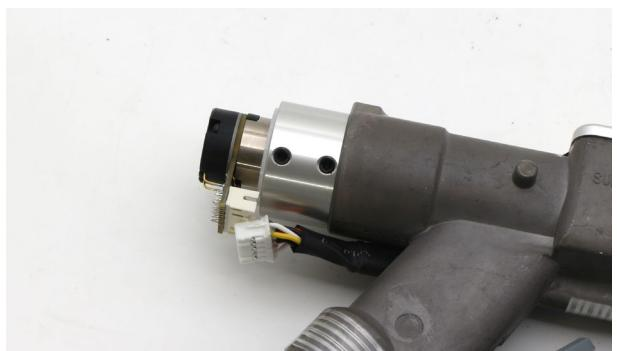
写真赤丸のイモネジを緩め、反射ミラーを取り外します。
