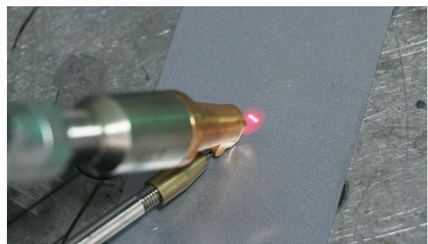
問題なければ溶接を開始します。「照射有効」をオンにし、トーチを母材に接触させ、トーチのボタンを押すことでレーザーが照射されます。**「照射有効」がオンのままパラメータ編集画面などに遷移してもレーザーは照射可能な状態です。溶接時以外はかならず「照射有効」をオフにしてください。**
