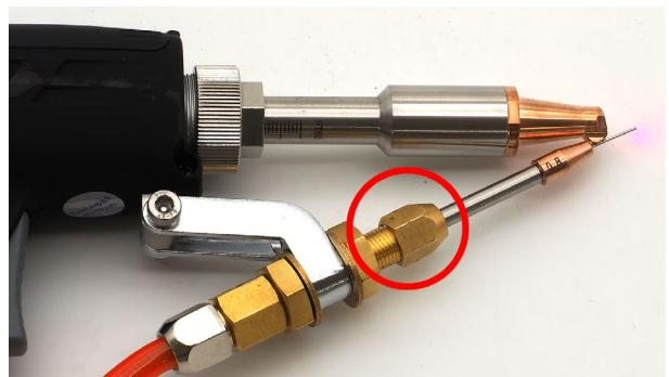
写真の赤丸のボルトを緩めることでワイヤー固定具の角度を調整できるため、ノズルの溝にワイヤーが沿うように調整します。
