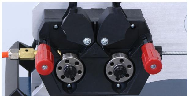
ワイヤー供給ノズルを取り外し、ワイヤーの直径に対応したノズルを準備します(取り付けはしないでください)。
