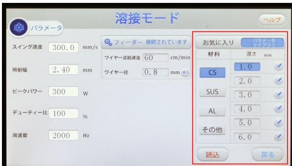
フィーダーの設定を行います。運転中・停止ボタンをタップし運転中にします。また、右上のボタンの表示が連続送給となっていることを確認してください。次にワイヤーの送給速度を設定します。母材の種類や厚さによって最適な速度は変化しますが、まずは120cm/minに設定してください。
