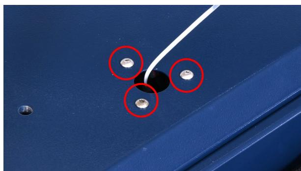
結束バンドを引き上げるとコネクタがでてきます。パトランプのコネクタと接続します。
