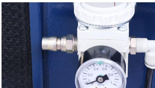
ガスレギュレーターのグレーの部分を上に引っ張り回転させることで圧力の調整が可能です。アシストガスは、窒素もしくはアルゴンガス（ステンレスの欠陥を軽減させるためアルゴンガス推奨）を使用し、流量は15～20L、圧力は0.2Mpaを推奨しています。
