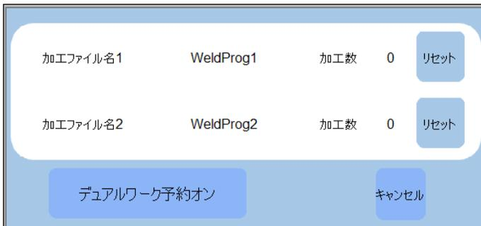
デュアルワークモードでは、外部トリガーによってステージ1とステージ2を自由に切り替えながら加工を行うことができます。このモードにより機械の空き時間の削減が期待できます。
