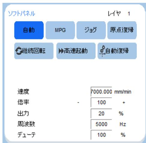
高速起動モードでは、加工終了後も機械の状態を「加工中」のまま維持することにより、状態切替時に発生する若干の遅延を削減します。同じ加工内容を繰り返し行う場合に適しています。
