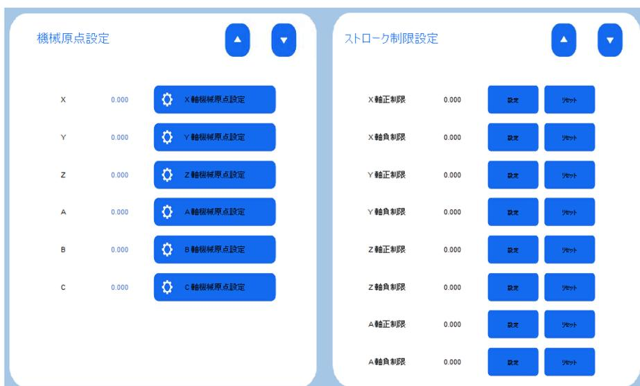
軸設定の機能画面は、機械原点設定（左側）とストローク制限設定（右側）に分かれています。軸設定ページには、有効化された軸（Pr21～Pr40）のみが表示されます。有効化された軸数が1ページで表示可能な数を超える場合は、「▼」または「▲」をクリックしてページを切り替えます。
