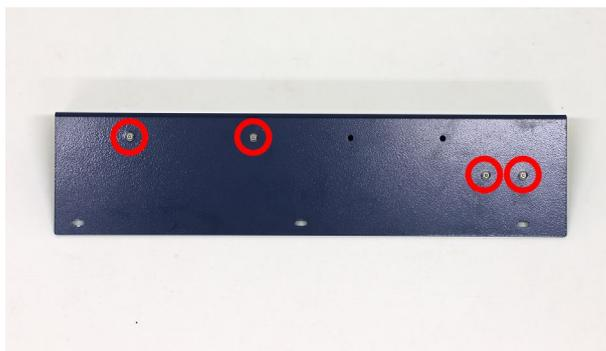
プレートAにアダプタボックスとケーブルホルダーを取り付けます。取り付け向きは写真を参考にしてください。
