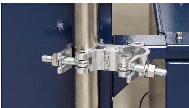
パイプクランプBに2本目のパイプを挿し込み固定します。
