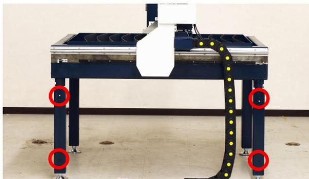
取り外したボルトでカバーを取り付けます。カバー及び支柱の上部には穴が2つ空いていますが、**支柱Bは上の穴、支柱Cは下の穴**にボルトを取り付けます。また、このボルトは後ほどケーブルキャリア補助プレートを取り付けるので仮止めにします。
