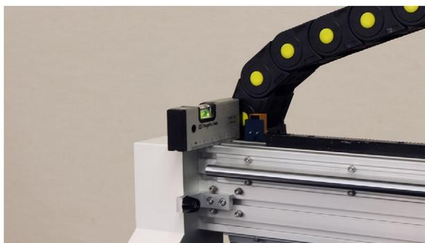
支柱下部のアジャスターで水平を調整します。アジャスターの下のナットを回すこと本体が上下に動きます。水平調整後、アジャスターの上のナットを締めて固定します。
