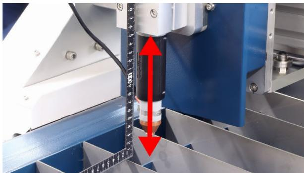
平行がずれている場合は、ウォーターベッドの裏側にあるボルト（赤矢印）を回すことでウォーターベッドが上下に動き調整することが可能です。ウォーターベッドを固定しているボルト（緑丸）を緩めてから調整してください。調整後、ナット（緑矢印）を締めて固定します。
