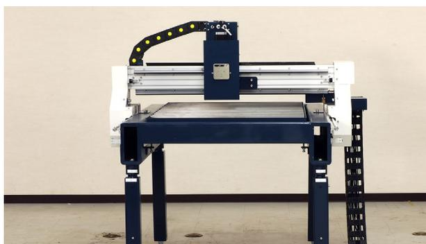
本体の水平を確認しながら床に固定します。X軸に水平器を置いて確認してください。
