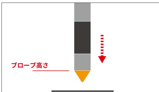
③ トーチ先端と素材が接するとステータスエリアの「導通」がONになる
