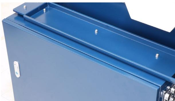
ケーブルキャリア補助プレートをカバー上部のボルトに引っ掛けるように取り付けボルトを締めてください(電装盤が浮いた状態が正常です)。
