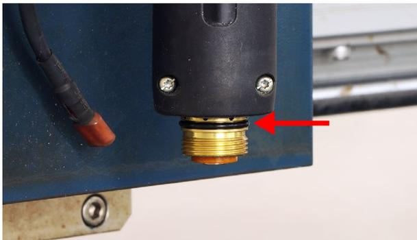
ソケットをトーチヘッドに取り付けケーブルを接続してください。
