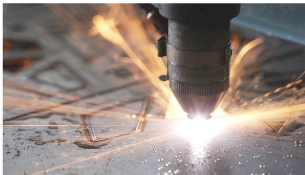
プラズマアークを発生させるためには素材を導通させる必要があります。素材にシートが貼ってあったり塗装やサビの影響で導通しない場合は加工できません。プラズマ電源→トーチ→素材→ウォーターベッド→プラズマ電源という順序で電気が流れます。
