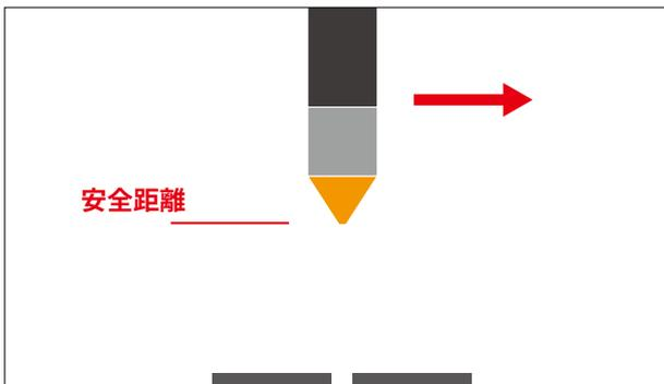
この**プローブ高さ**と**安全距離**を調整することでプローブの動作時間が短縮できます。詳細設定で数値を設定できます。
