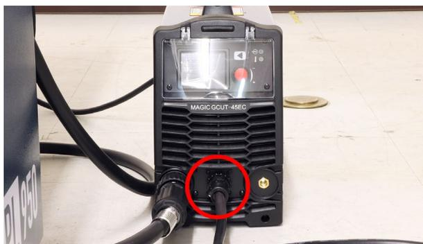
アースクリップをプラズマ電源に接続します。奥まで挿し込みヒネるようになって接続してください。
