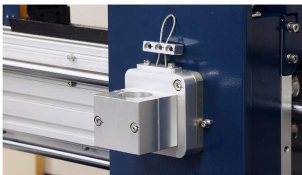
固定用の部品に付属のボルトを入れて本体に固定します。この時、真ん中のボルトのみワイヤーをくぐるようにして固定してください。
