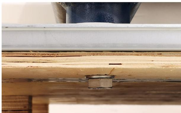
支柱の上部のボルトを六角レンチで取り外します。
