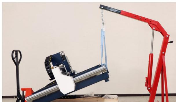
アルファベットが同じ箇所、また同じ向きになるように支柱を取り付けます。先ほど支柱から取り外したボルトを六角レンチで取り付けてください。取り付け後、ゆっくりと本体を床に降ろします。
