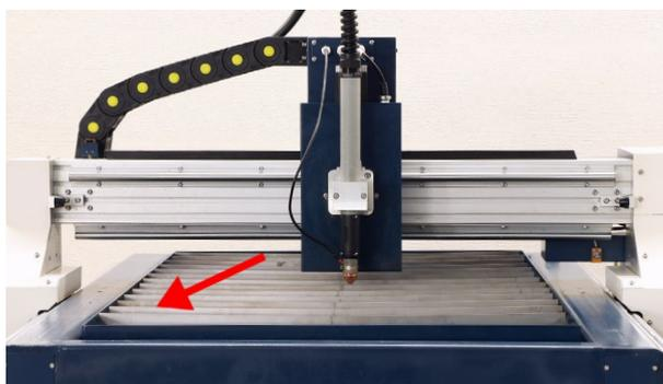
ウォーターベッドと本体が平行か確認します。写真のようにL字定規を使用してウォーターベッドとトーチマウントの距離を測ります。これをウォーターベッドの四隅で確認してください。
