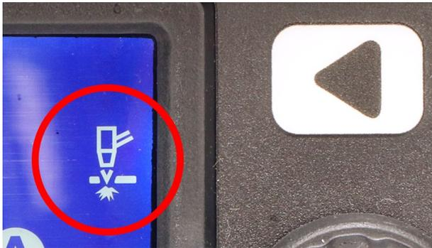
トーチが素材の真上にあることを確認し、ソフトウェアの「プローブ」をクリックします。プローブとは素材の高さを検出する動作です。トーチが素材に接した際に導通ステータスがオンになり、トーチが素材から離れれば正常です。
