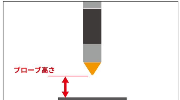
②プローブ開始位置と素材表面の距離が長い場合はプローブ高さを小さくします。素材が平面で傾きがない場合でも、2mm以上の距離を開けることを推奨します。
