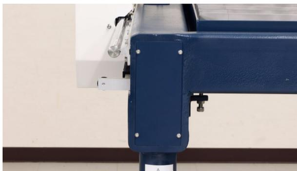
本体向かって右側にカバー（穴が空いているカバー）を取り付けます。支柱B・Cに取り付いているボルトを4つ取り外します。
