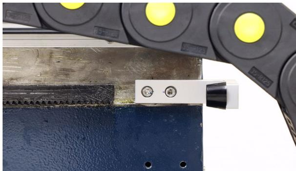
写真の位置にトーチマウントを取り付けます。トーチマウントは磁石で密着します。
