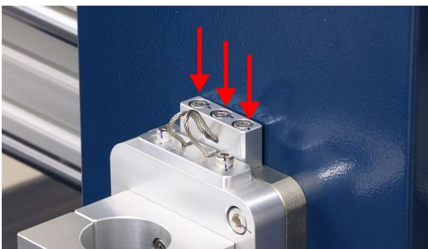
トーチをトーチマウントに取り付けます。X軸の背面にトーチが梱包されているので取り外します。
