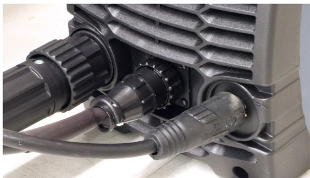
エアコンプレッサーを用意し、プラズマ電源に接続します。付属のホースを使用してください。**エアの推奨供給圧力は0.4Mpa～0.6Mpaです。1.0Mpaを絶対に超えないようにしてください。超えた場合、プラズマ電源が破損する恐れがあります。**
