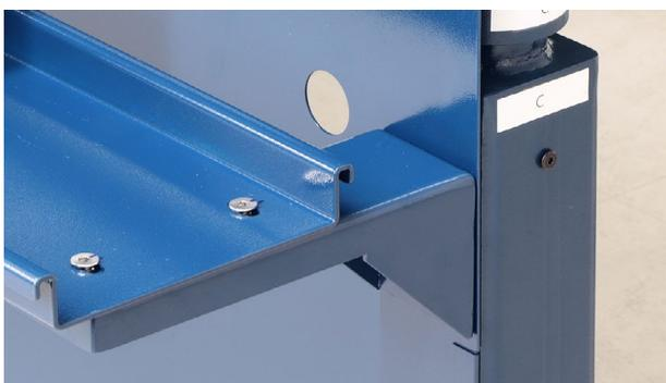
ケーブルキャリアをケーブルキャリア補助プレートに載せ、ケーブルを穴に通します。
