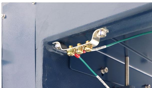
アース線をカバーに空いている穴を通し電装盤側にだします。
