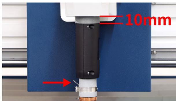
本体上部に取り付けているケーブルをトーチに取り付けます。写真のように奥まで差し込んでください。
