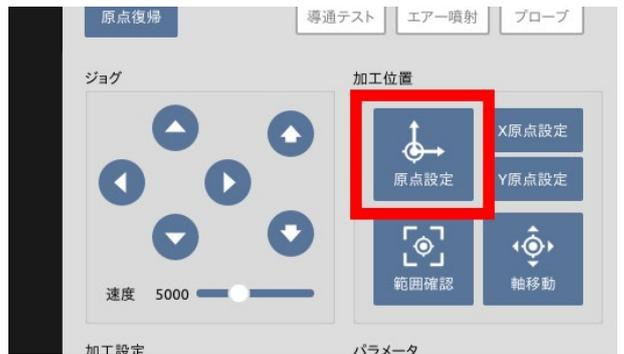
「加工範囲確認」をクリックすると、トーチがデータの外周をなぞり加工範囲を示します。加工範囲が素材に収まっているか確認してください。
