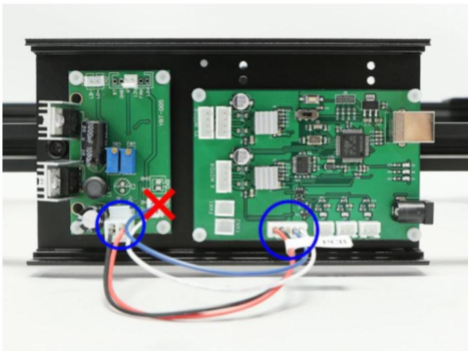
最期に写真の様に接続されていることを確認してください。確認完了後にACアダプタをコントロール基板に接続してレーザーユニットのファンが回るか確認してください。
