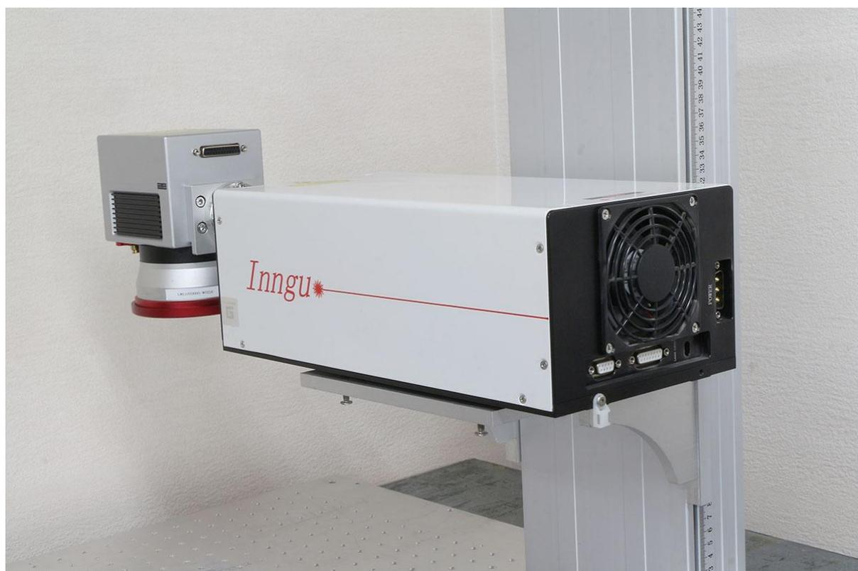
②レーザーヘッドを支える4つのネジを外し、ヘッドを取り外します。
