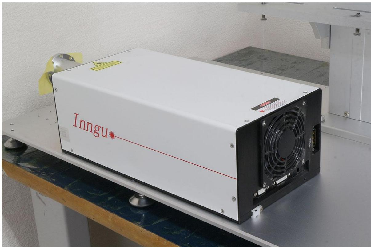
⑤新しい発振器を用意し、逆の順序で取り付けて完了です。
