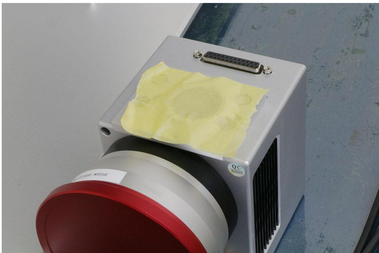
④発振器下部のボルトを外し、発振器を取り外します。
