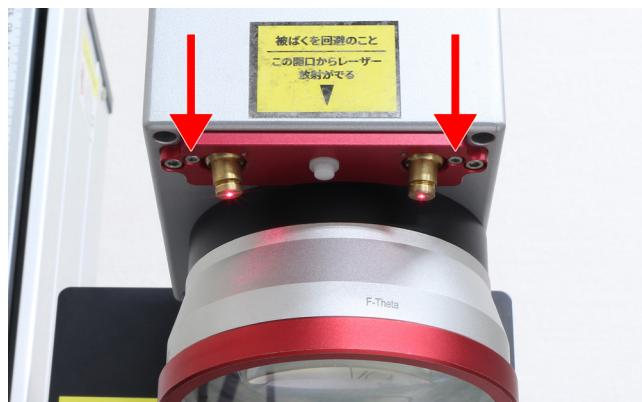
するとpointerが照射される金の筒が動かせるようになるので、ライトで表示されている四角の中心から手前に10mmの位置にpointerが来るよう調整し、ネジを締めます。
