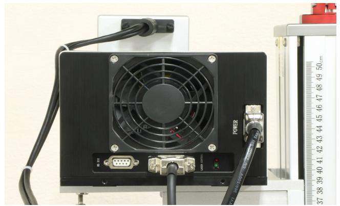
コードは接続後、結束バンドで纏め、レーザーヘッドの後ろ側に固定してください。
