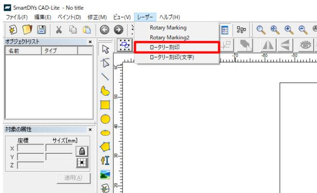
まず、「ロータリー刻印」ウインドウ下部の「設定」をクリックし、「有効」にチェックが入っていることを確認したら、回転の方向とギア比を入力します。ギア比の数値は回転軸によって異なります。以下をご確認ください。
