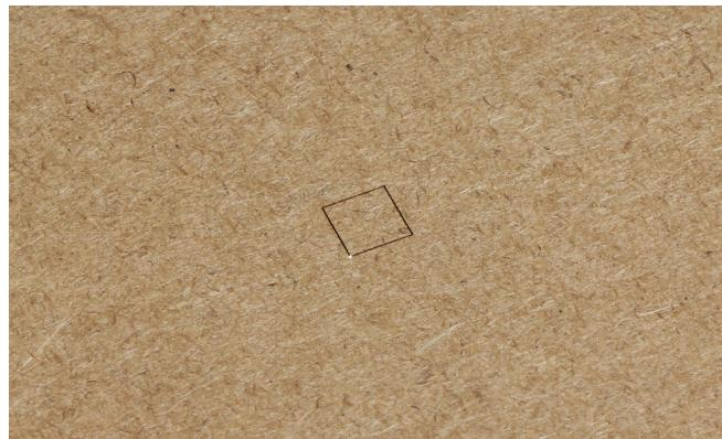
基準値に合わせた高さを 1mm ずつずらしながら加工を行い、一番刻印時の音が大きく、また、加工結果の色が濃くなる高さを見つけ出します。
