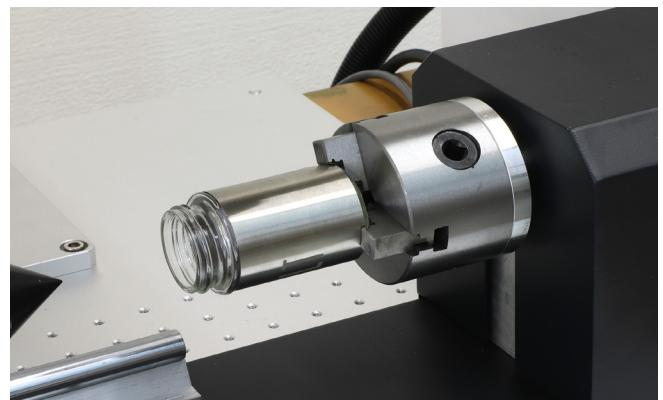
左側の突起を素材に接着するまでスライドさせます。突起が取り付いている下部にネジ穴があり、取っ手を差し込み回すことで突起を固定することができます。
