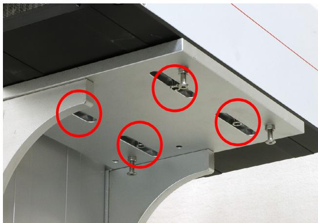
レーザーを台座に載せる位置は写真を参考にしてください。矢印部分が 90mm になるよう設置します。
