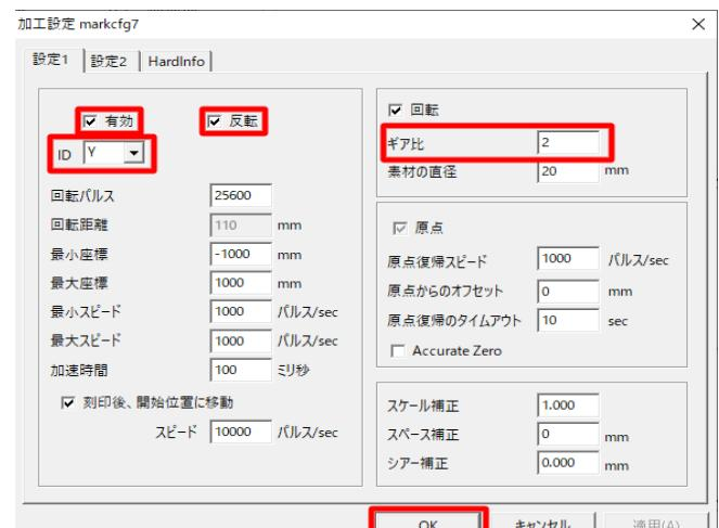
「ロータリー刻印」ウィンドウに戻ったら、素材を設置する前に計測した、素材の直径を入力します。
