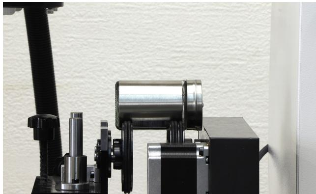
使用する回転軸に素材を設置したら、加工機本体の電源を入れ、加工する面に気をつけながら高さ調整を行います。通常の加工の通りデータの作成やパラメータ調整を行い、メニューバーの「レーザー」内、「ロータリー刻印」を開きます。
