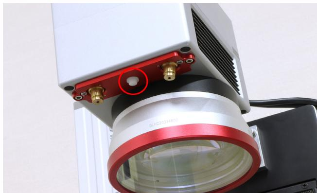
写真のようにレーザーポインターの光が2つ照射されており、本体上部のハンドルを回すことでこの光が近づいたり離れたりします。2つの光が重なるように調整します。
