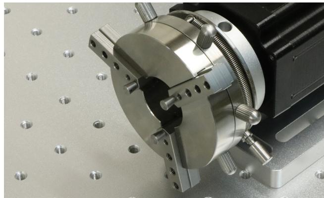
写真突起部分にバネの先端の丸い部分を引っ掛けます。リングの外側に加工する場合はバネを手前に引いて、バネの先端を穴に差し込み（3つの固定具が外側に開く）、リングの内側に加工する場合は奥側に引っ張って穴に差し込みます（3つの固定具が内側に閉じる）。
