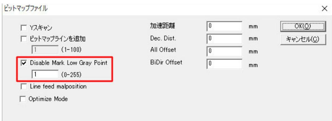
まずは画像の濃淡をレーザーの強弱で表現する設定をご紹介します。データ内の一一番濃い箇所がパラメータで設定した濃さになります。写真等の刻印に向いています。
