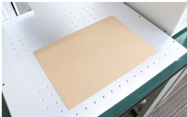
素材からレンズまでの距離を基準値に合わせます。ハンドルを回すことでレーザーヘッドの位置が上下します。基準値は 215mm です。
