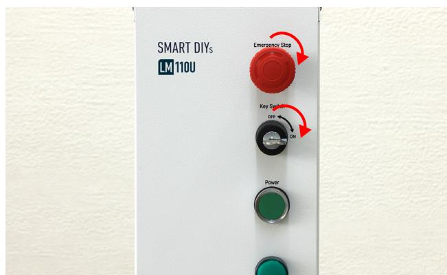
電源スイッチを押します。すると電源スイッチ下のランプが点灯し、本体のファンが回り始めます。
