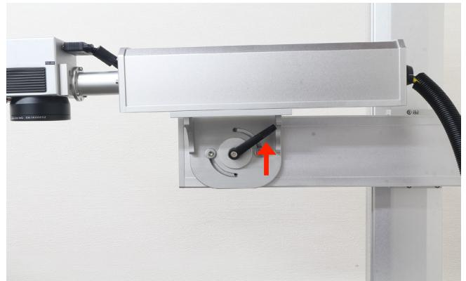
レーザー頭が動かせるようになるので、水平が取れる位置に調整し、ネジとハンドルを固定します。
