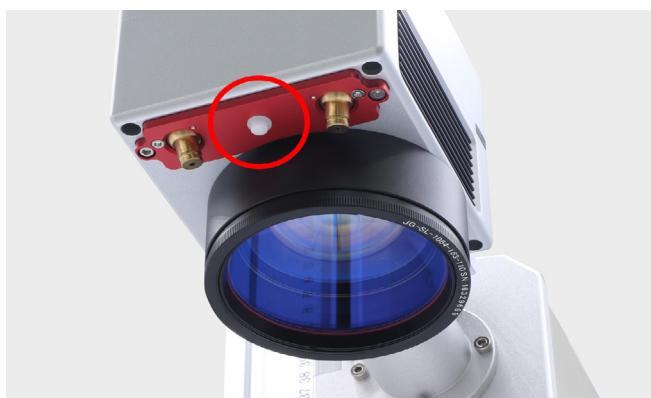
写真のようにレーザーポインターの光が2つ照射されており、本体上部のハンドルを回すことでの光が近づいたり離れたりします。2つの光が重なるように調整します。
