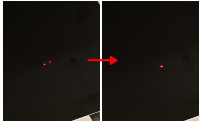
高さ調整が完了したら、再度レーザーヘッドのボタンを押し、レーザーポインターをオフにしてください。
