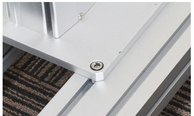
支柱が水平になっているか確認します。支柱のレーザーヘッド取付位置に水平器を載せ、ずれがある場合は調整を行います。水平になるまでアジャスターの下の方のナットを回していきます。
