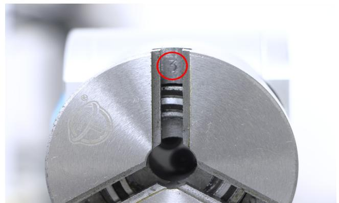
写真左、赤枠内のネジを緩めることで素材を設置する際の角度を変更できます。
