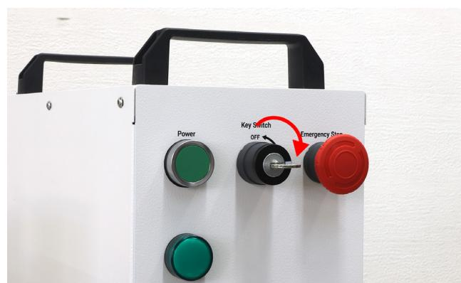
電源スイッチを押します。すると電源スイッチ下のランプが点灯し、本体のファンが回り始めます。※ MOPA 型の場合、使用状態によってファンが起動と停止を繰り返します。
