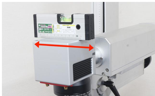
次にY方向のずれを調整します。水平器を画像の通りに置き、レーザーヘッドの台座の2つのネジとハンドルを緩めます。
