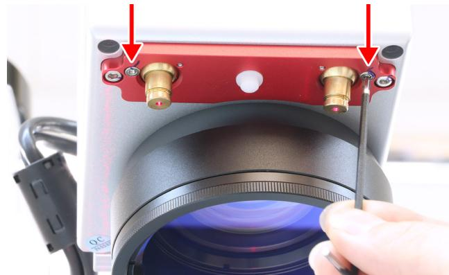
するとポインターが照射される金の筒が動かせるようになるので、ライトで表示されている四角の中心にポインターが来るよう位置を調整し、ネジを締めます。
