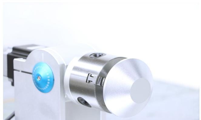
チャックを外した場合は固定具に挿し直す必要がありますが、チャックは挿し込む位置が決まっています。チャック側と固定具側に番号が割り振られているので、番号が一致した箇所に挿し直してください。
