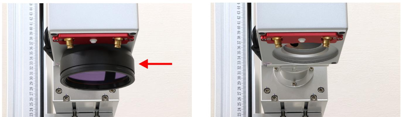
カバーからレンズを取り外し、交換用のレンズに取り付けます。レンズをガルバノスキャナに取り付けます。
