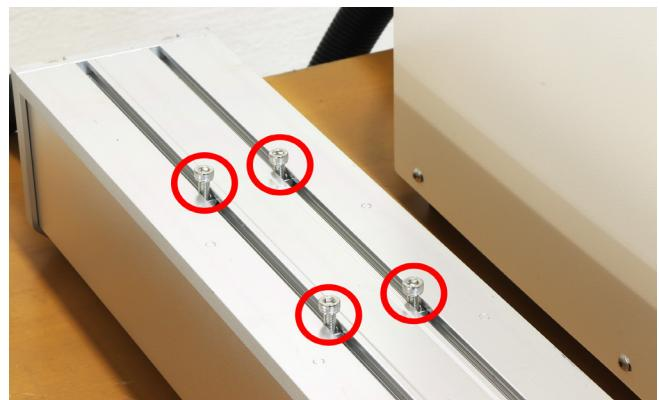
レーザーヘッドをひっくり返し、Z 軸ステージの台座に設置します。先ほど取り付けたボルトが台座に触れてしまう場合はナットをスライドさせ、干渉しない位置まで動かしてから設置してください。
