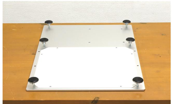
加工ベッドを元に戻し、水平器で加工ベッドの水平を確認します。アジャスターを回すと高さが変わるので調整してください。調整後、ナットで固定します。
