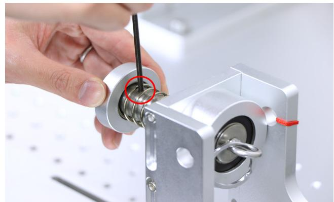
素材を設置する際、赤枠内のフックを引っ張りながら位置の調整を行う必要があります。紐で繋がれたプレートを挟み込むことにより、常にフックを引っ張る必要がなくなるため、位置の調整がより簡単に行えます。
