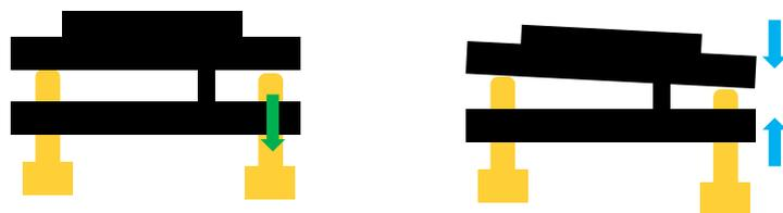
調整ネジを**反時計回り**に回すことで間隔が狭まりミラーが傾く
