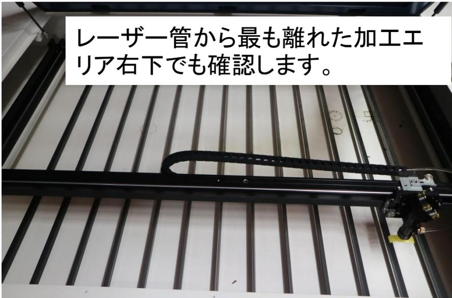
レーザー管から最も離れた加工エリア右下でも確認します。
