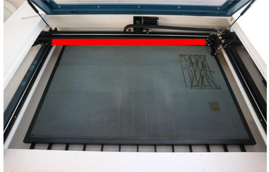
Y軸を加工エリア上部に移動させます
