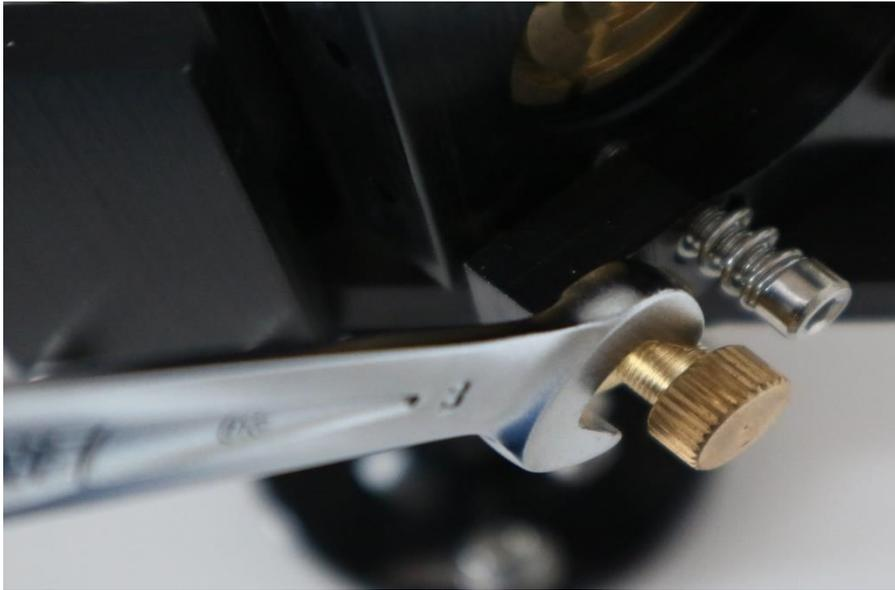
ズレがなくなるように調整し、調整ネジ固定
