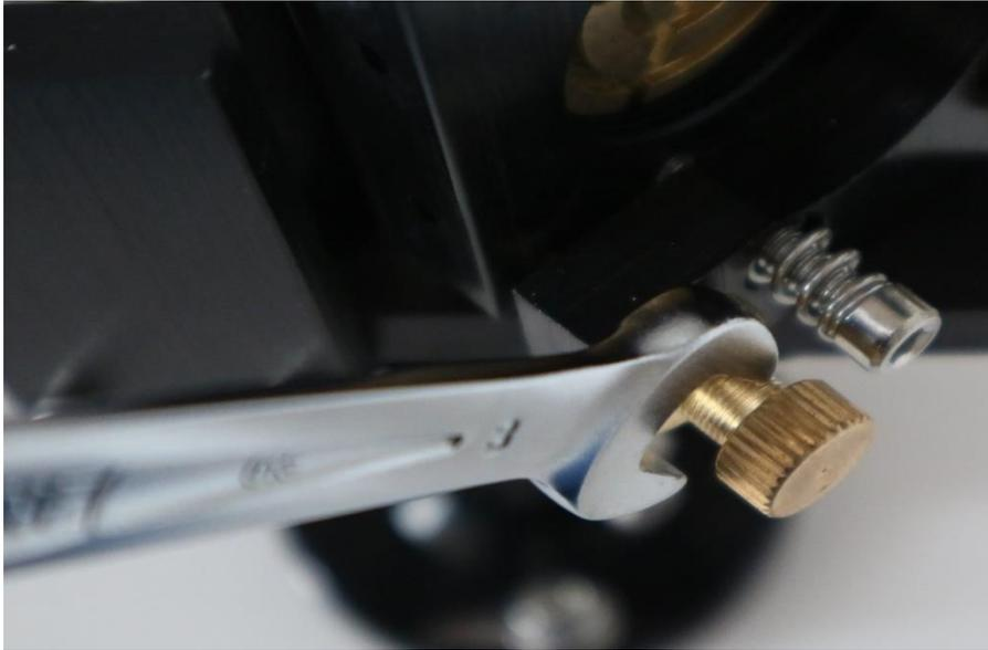
3か所の調整ネジ固定ナットを緩めます
